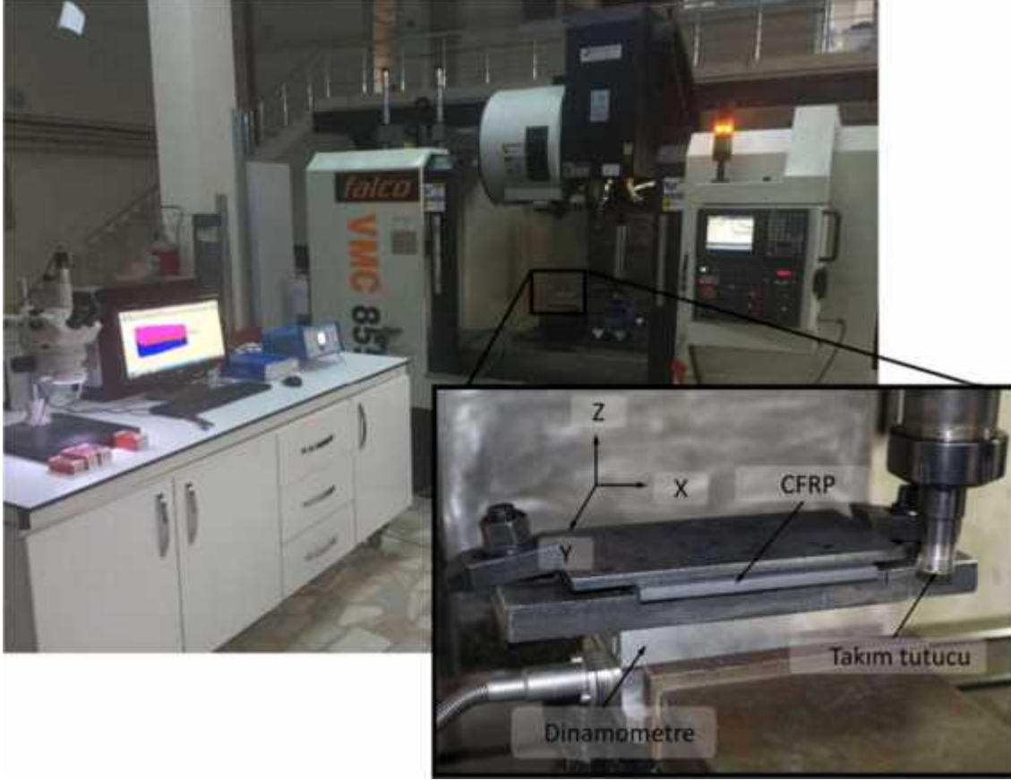
ekil 26: Deneylerde kullanılan CNC dik i leme merkezi ve deney düzene inin genel görüntüsü.
