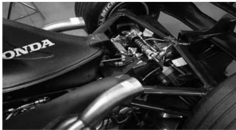
ekil 9: Formula 1 yarış arabasındaki karbon fiber takviyeli süspansiyon ve vites kutusu görünümü (Mallick, 2008).
