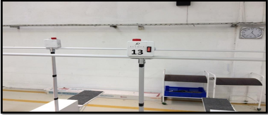
Şekil 48: İkaz sistemi (Andon - ikaz ışığı).
