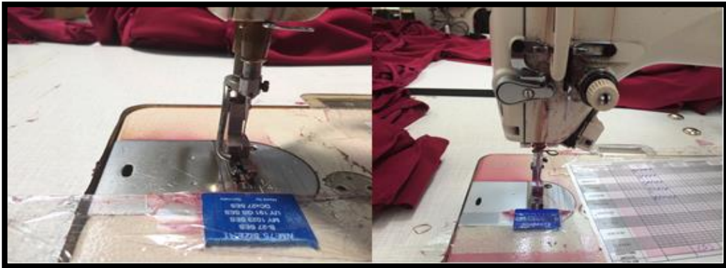
Şekil 45: Kompresör ve magnet yardımıyla artık ipliği yok etme.
