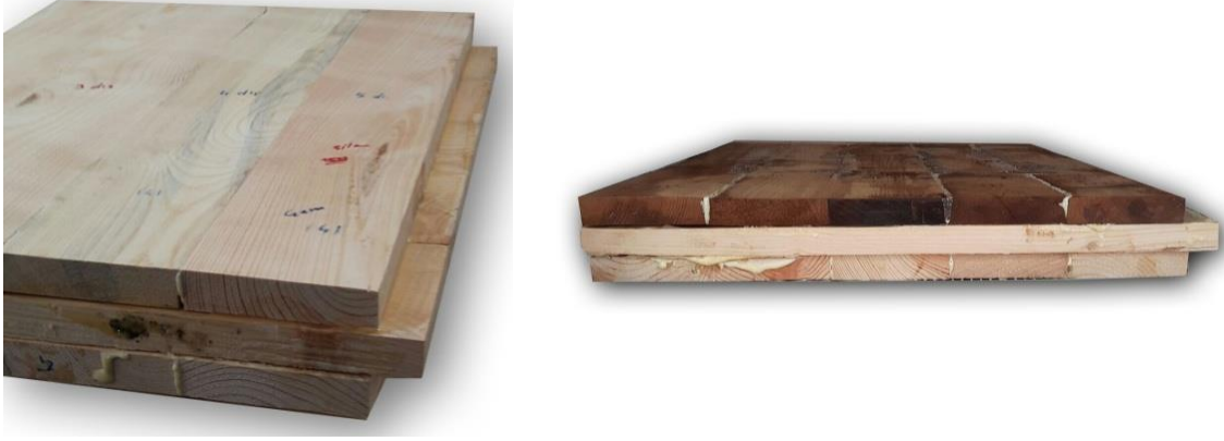
Şekil 30: Hazırlanan çapraz lamine panel örneği (Fotoğraf: Z. Eda ÖZAN, 2017).
