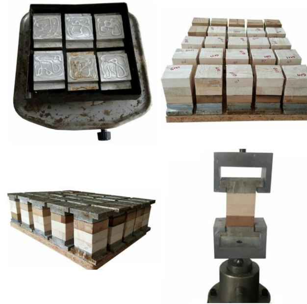
Şekil 32: Yüzeye dik çekme direnci deneyi için hazırlık aşaması (Fotoğraf: Z.Eda ÖZAN, 2017).
