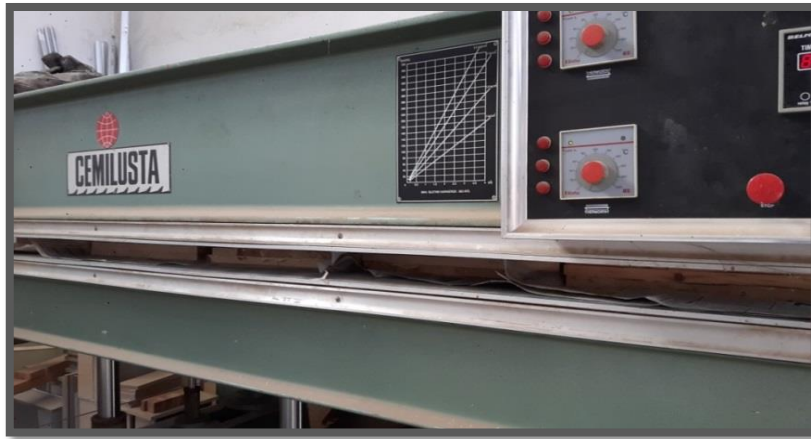
Şekil 29: Tabakalar arası yapışmada presleme (Fotoğraf: Z. Eda ÖZAN, 2017).
