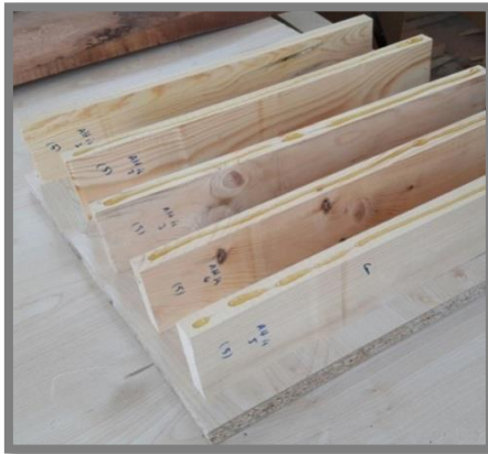
Şekil 27: Örneklerin işkence ile sıkıştırılması (Fotoğraf: Z. Eda ÖZAN, 2017).
