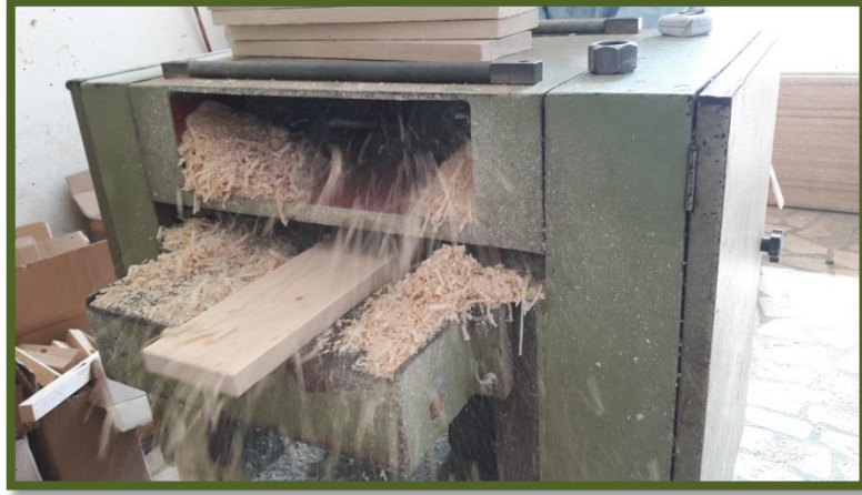
Şekil 26: Kalınlık makinesinde yüzey düzgünlüğünün sağlanması (Fotoğraf: Z. Eda ÖZAN, 2017).
