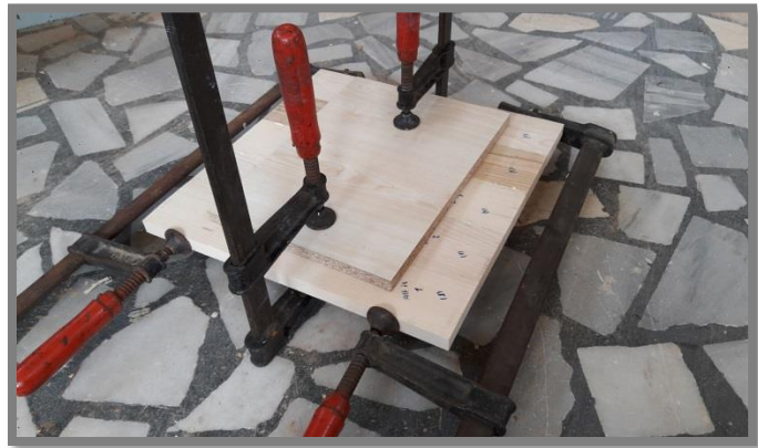
Şekil 27: Örneklerin işkence ile sıkıştırılması (Fotoğraf: Z. Eda ÖZAN, 2017).
