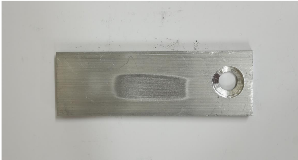
Şekil 29: RWAT testi sonrası aşınmış numune yüzeyi.
