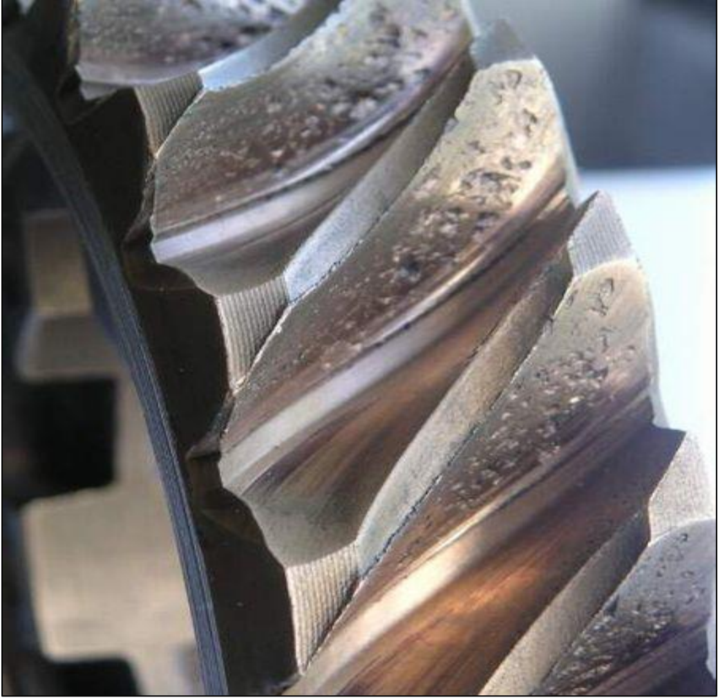
Şekil 6: pitting çukurcuk oluşumu (URL-3, 2017).
