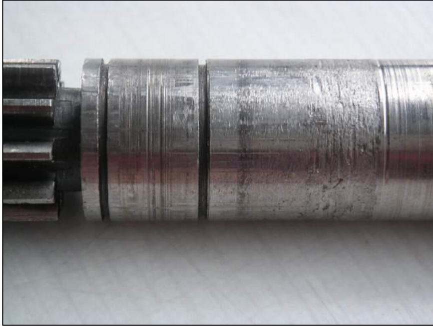
Şekil 4: Abrozyon (çizilme) aşınması (URL-3, 2017).
