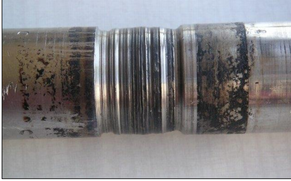
Şekil 5: Mil yüzeyi çizilme aşınması (URL-3, 2017).
