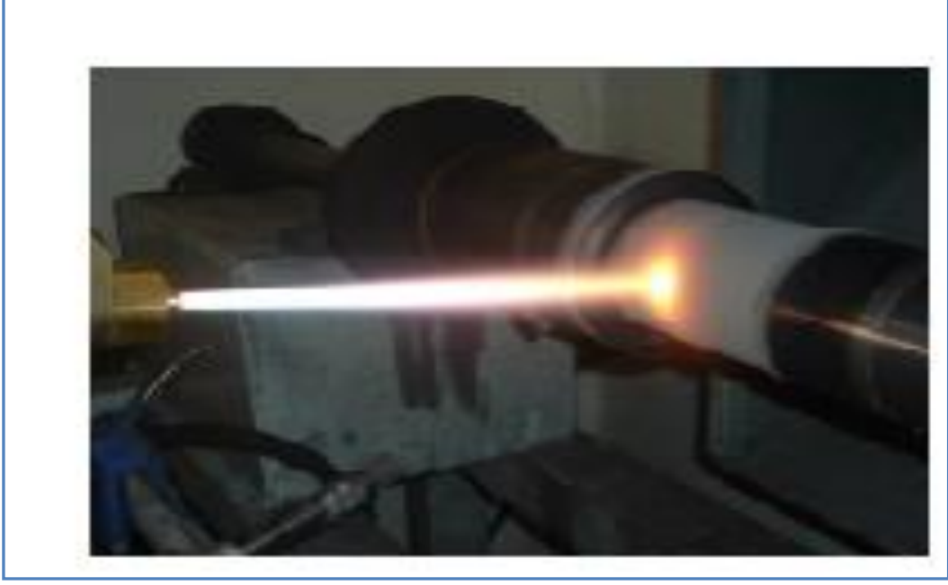
Şekil 14: Hvof kaplama yönteminin uygulaması (Yonar, 2009).
