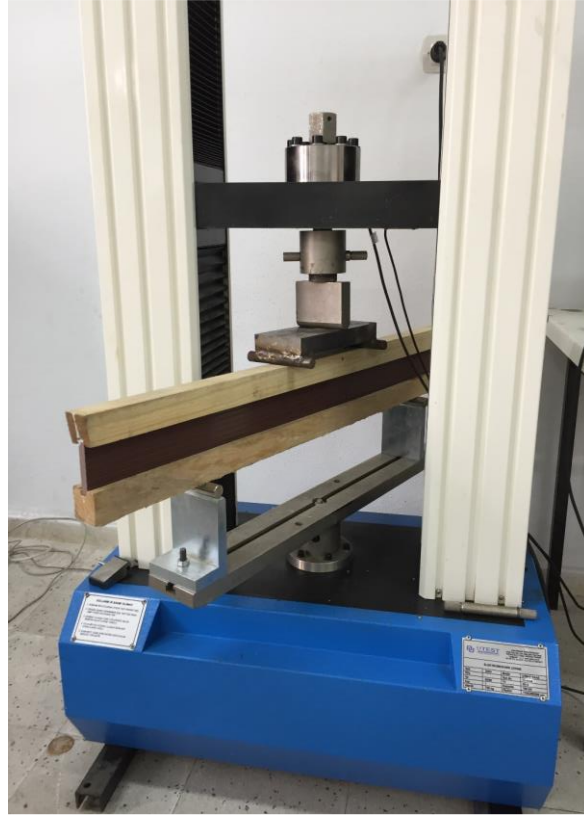
Şekil 25: Kirişlerde Tahribatlı Deney Düzeneği
