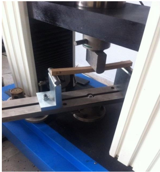
Şekil 2.3: Örneklerin eğilme direnci ölçümü.
