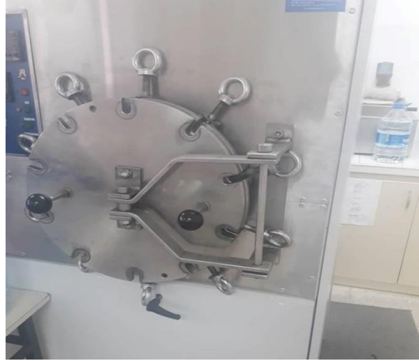
Şekil 2.3: Emrenye işleminde kullanılan tank
