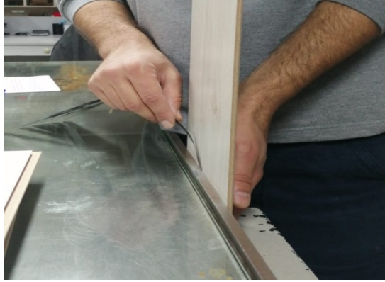
Şekil 3.8: Genişlik Düzgünlüğü Kontrolü
