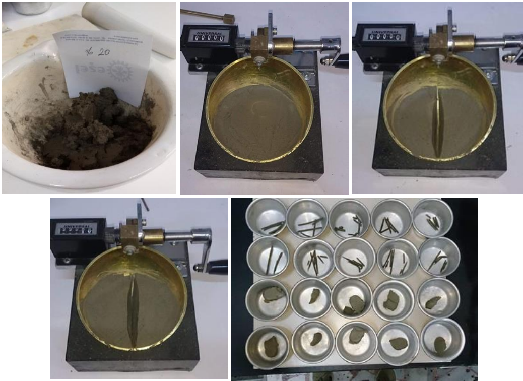
Şekil 2.13: Likit limit deney numunelerinin hazırlanması ve deneyin yapılması.
