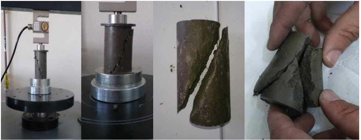
Şekil 3.10: Numunelerde gözlenen yenilme düzlemleri.
