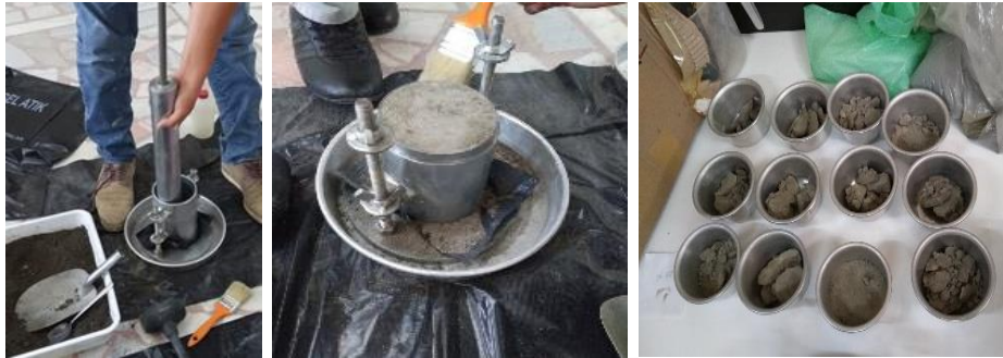
Şekil 2.15: Standart Proktor Deney numunelerinin hazırlanması.
