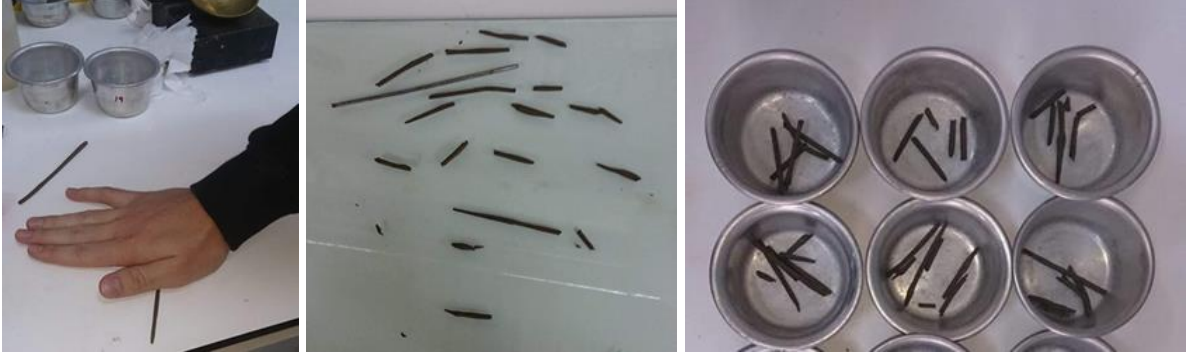
Şekil 2.14: Karışım numunelerinin plastik limit deney yapılışı.
