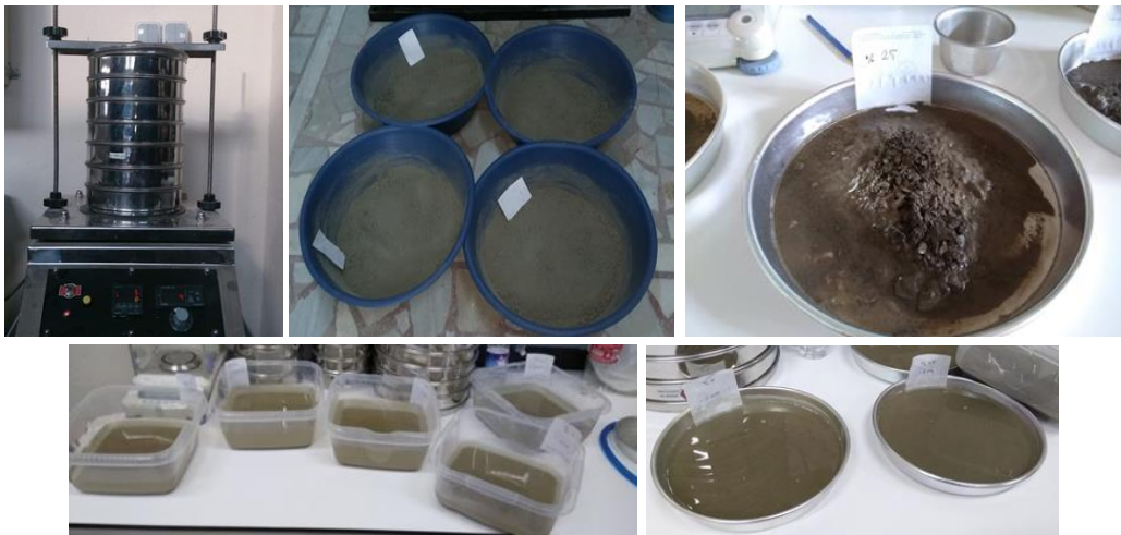
Şekil 2.10: Numunelerin elek analizi aşamaları.
