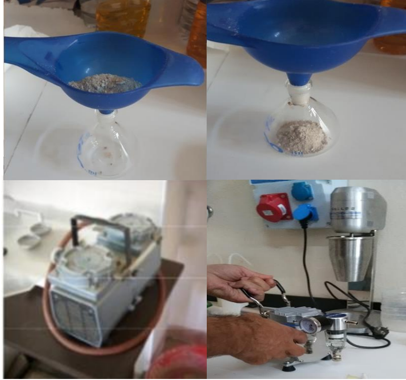
Şekil 2.12: Piknometre deney yapım aşamaları.
