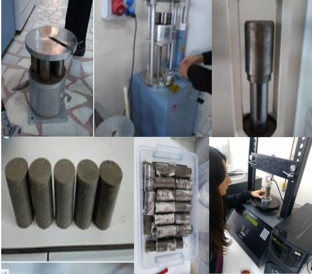
Şekil 2.18: Serbest Basınç deneyi yapım aşamaları.
