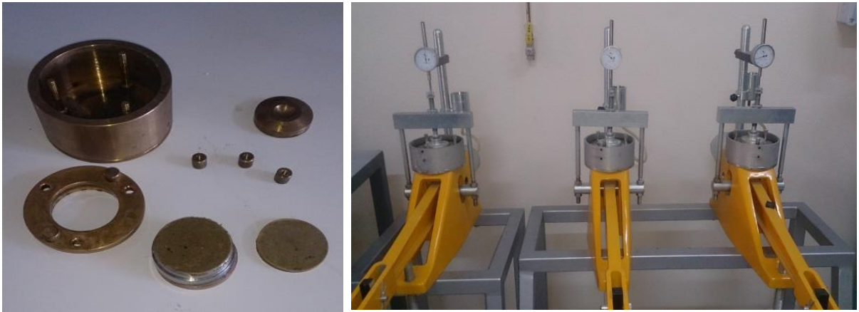
Şekil 2.16: Konsolidasyon deney numunelerinin hazırlanması.
