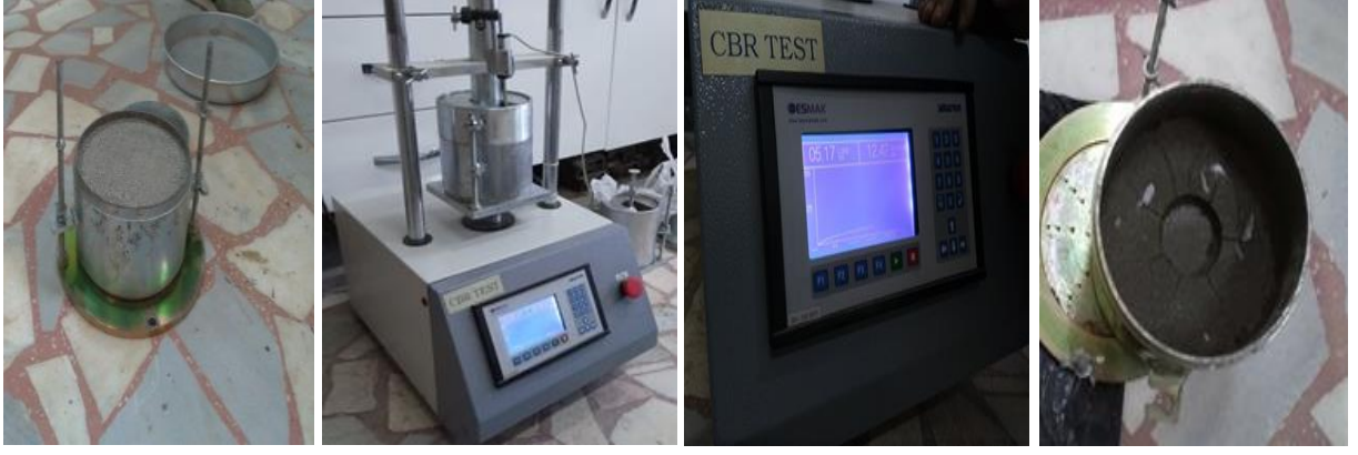
Şekil 2.17: CBR deney numunelerinin hazırlanması ve deneyin yapılışı.
