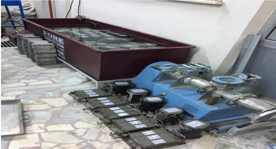
Şekil 3.6: Harçların kalıplara yerleştirilmesi ve kür havuzu.
