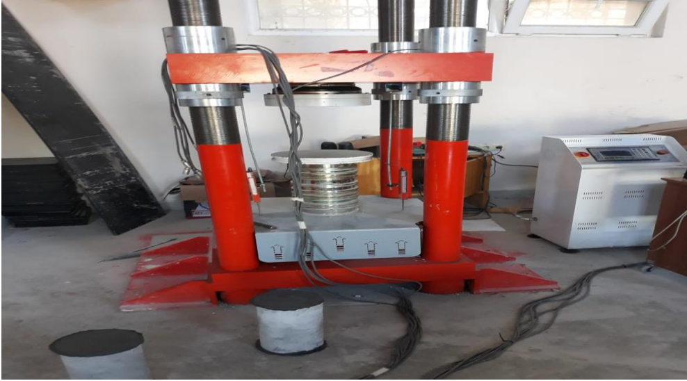
Şekil 3.15: Elastisite modülünün belirlenmesinde kullanılan deney düzeneği.
