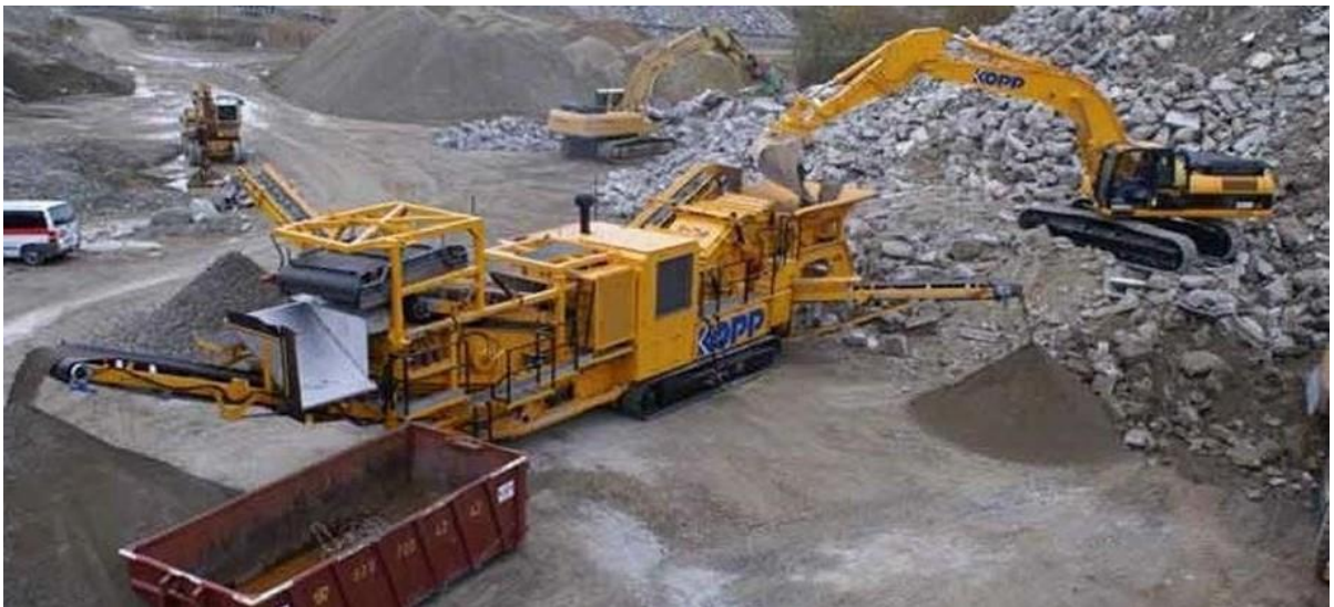
Şekil 2.2: Geri dönüşüm agregasının kaynaktaki ayrıştırılması.
