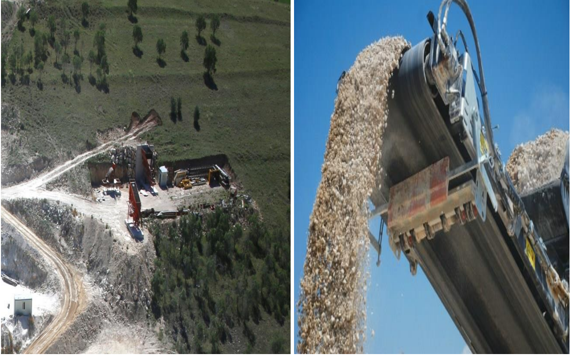
Şekil 2.5: Geri dönüşüm tesisinde geri dönüşüm agregası elde edilmesi.
