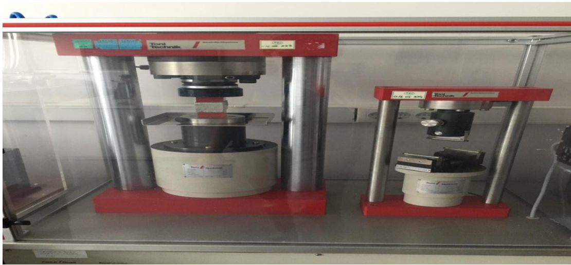
Şekil 3.9: Donma-çözülme uygulanan numunelerde basınç dayanımı tespiti.
