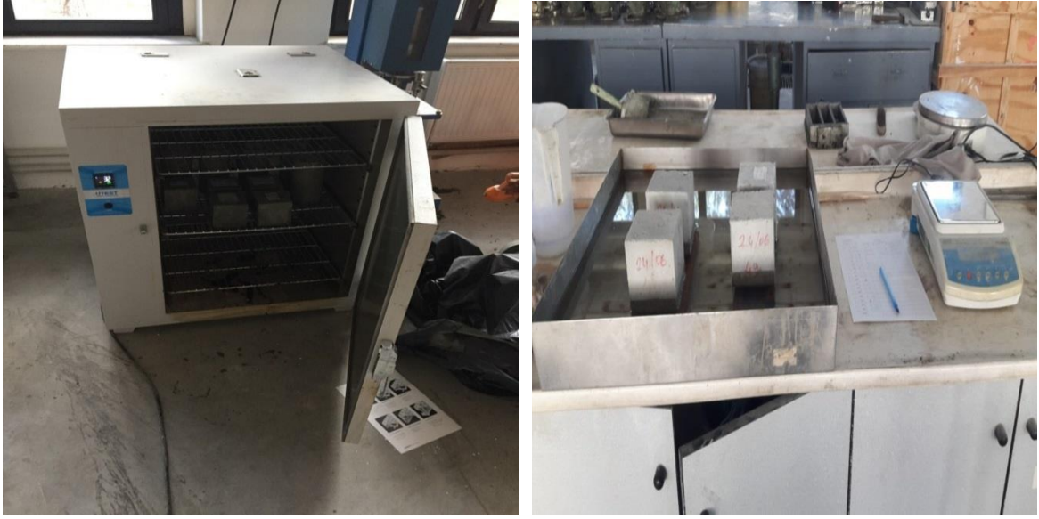
Şekil 3.13: Harç numunelerinin etüvde kurutulması ve kılcak su emme deneyi.
