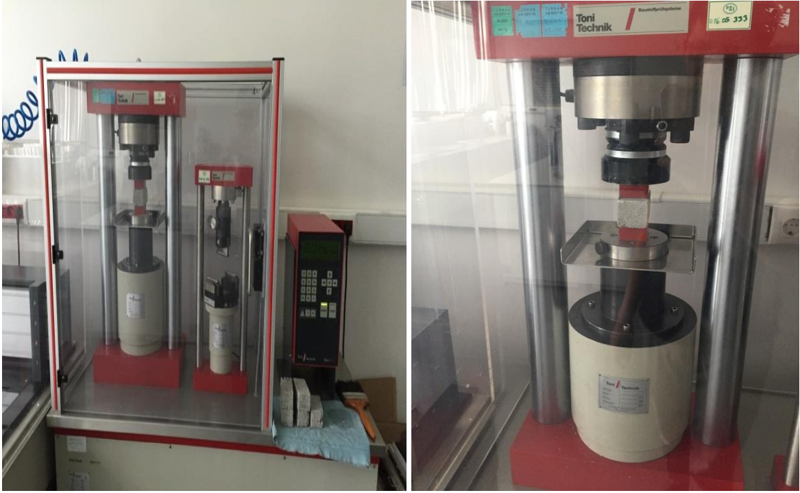
Şekil 3.11: Numunelerde basınç dayanım deneyi.
