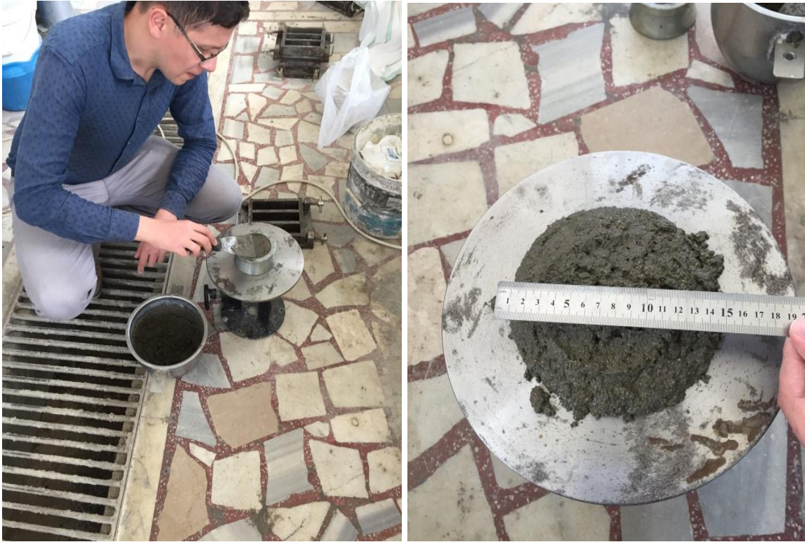
Şekil 3.7: Harçlarda yayılma çaplarının belirlenmesi.
