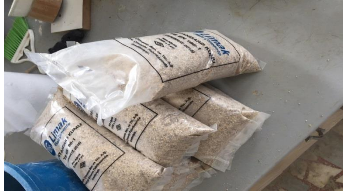
Şekil 3.2: Harç yapımında kullanılan standart kum.
