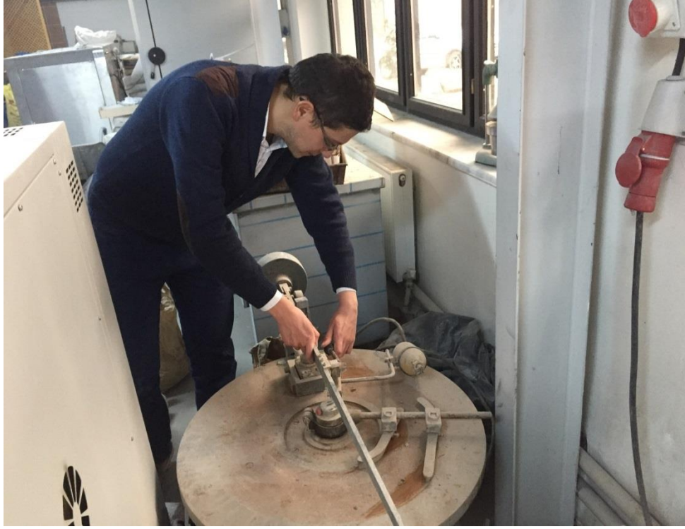
Şekil 3.14: Aşınma (Böhme) Deney Düzeneği.
