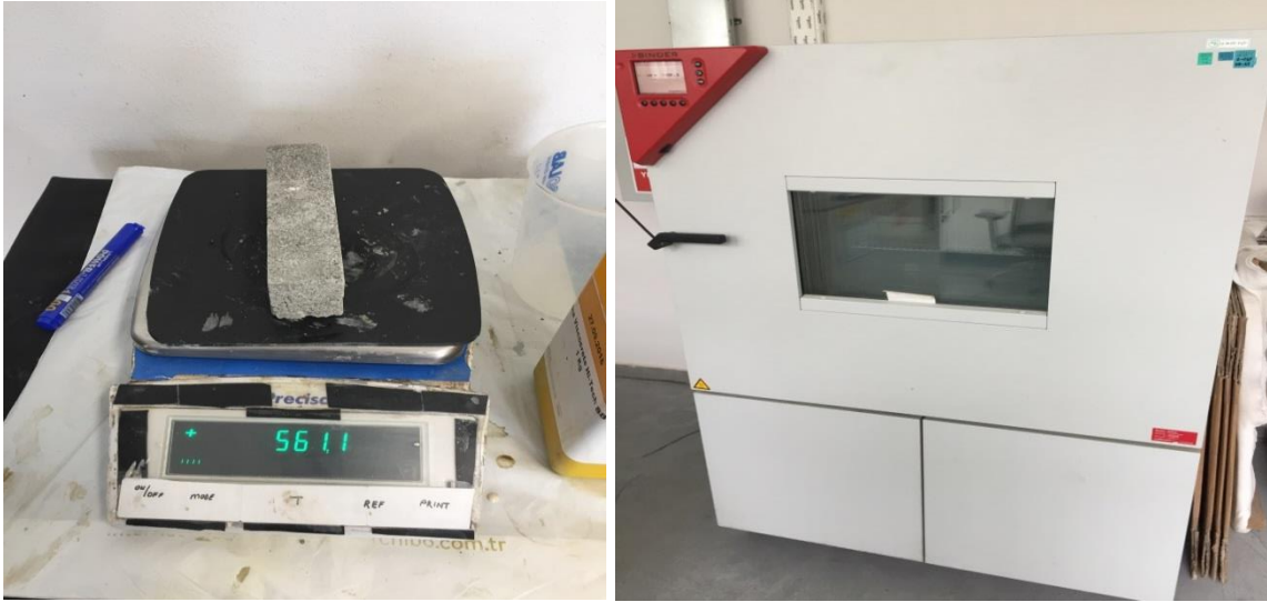
Şekil 3.8: Numunelerin etüvde kurutulması ve tartılması.
