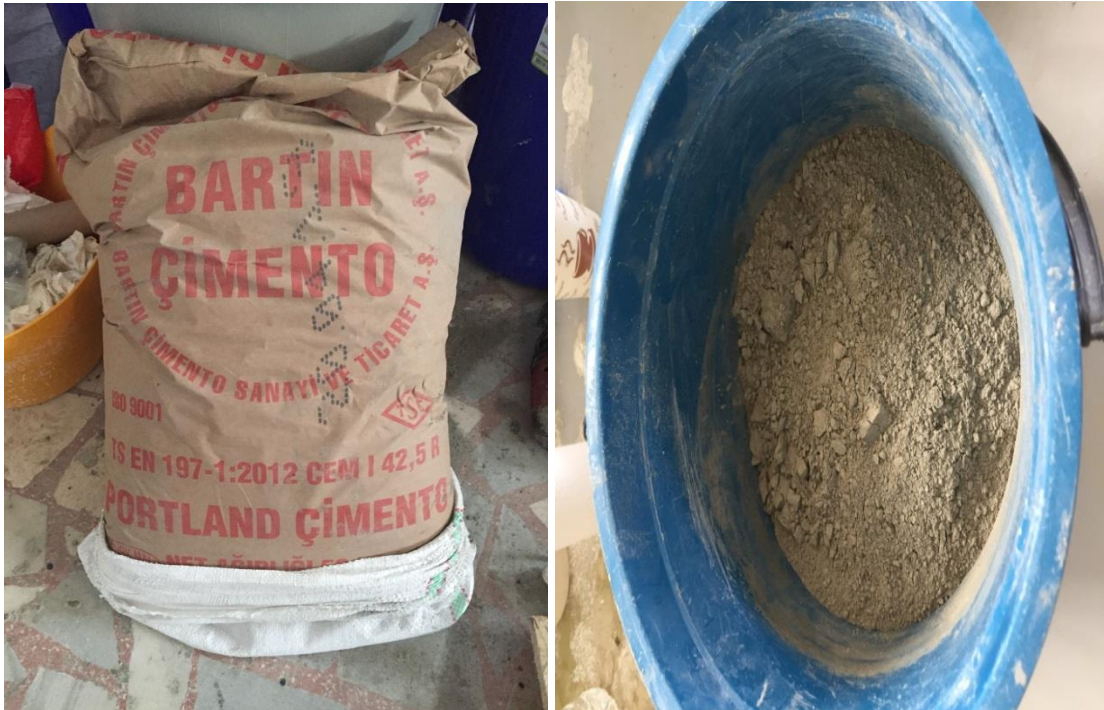
Şekil 3.1: Harç yapımında kullanılan CEM I 42,5 R Portland çimentosu.
