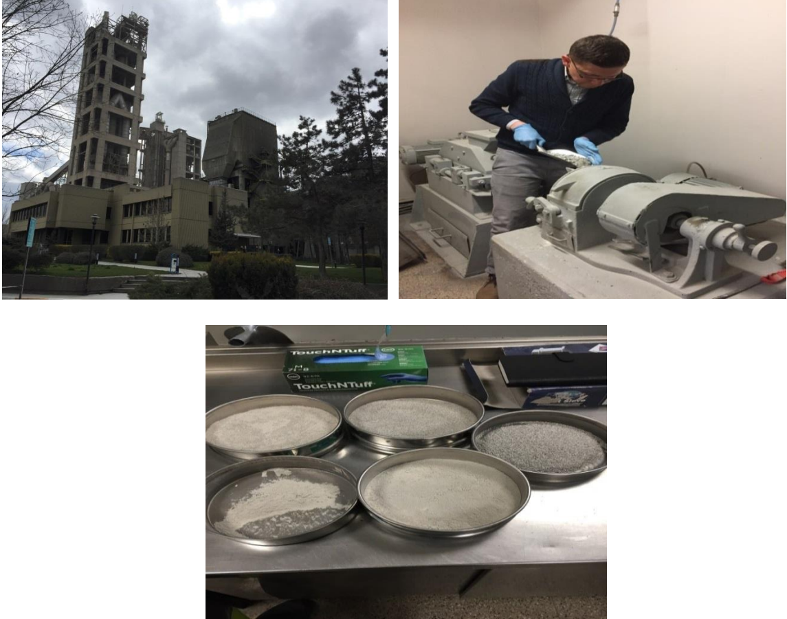
Şekil 3.4: Geri dönüşüm agregası elde etme süreci.
