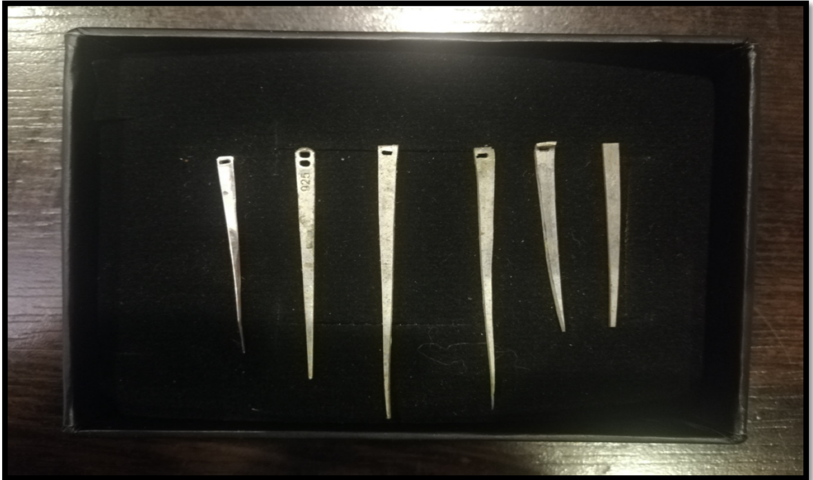
Şekil 2.12: Bir tel kırma iğnesinin sağdan sola doğru yapım aşamaları
