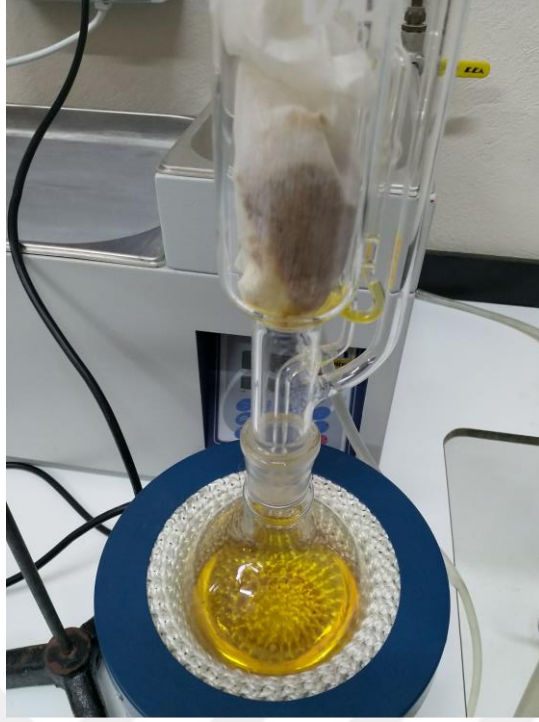
Şekil 3.2: Soxhlet cihazı ile ekstraksiyon işlemi.
