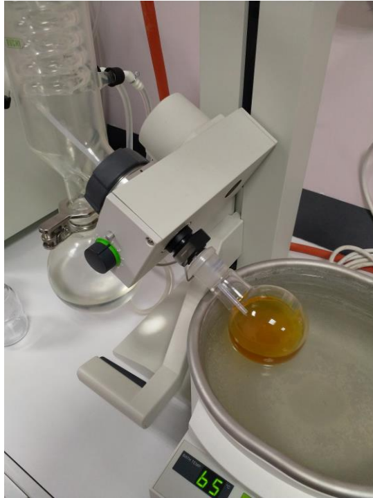
Şekil 3.3: Rotary evaporator cihazı ile özütten çözücünün uzaklaştırılması.
