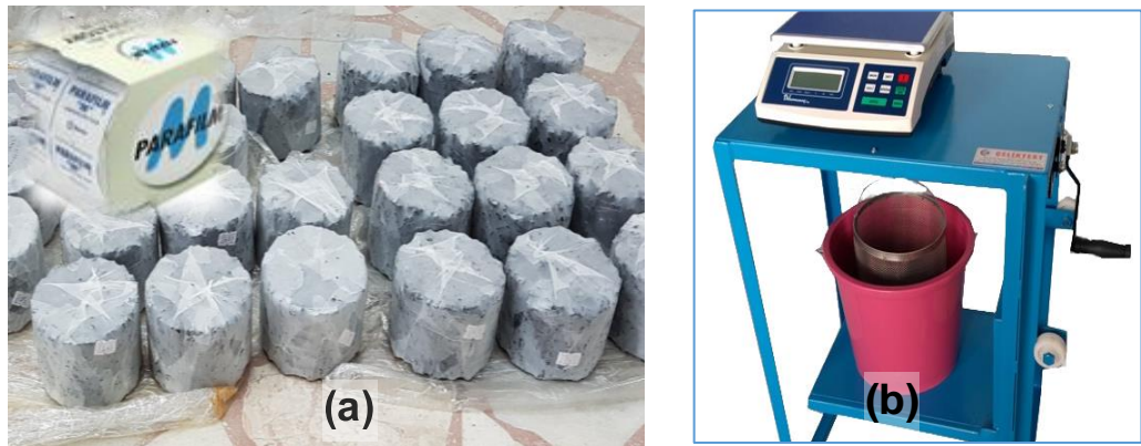
Şekil 5.8: Numunelerin boşluk analizleri (a) parafilmle kaplı numuneler (b) özgül ağırlık sehpası
