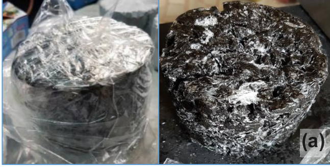
Şekil 5.15: Numunelerin koşullandırma aşamaları (a) dondurucudan çıkarılan numune, (b) 60 °C'lik su banyosunda bekletilmesi
