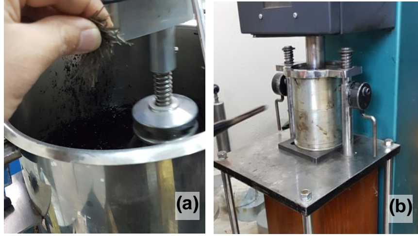
Şekil 5.7: Geçirimli asfaltın hazırlanma aşamaları (a) mikserle karıştırılan karışıma lif ilave edilmesi (b) numunenin Marshall tokmağı ile sıkıştırılması
