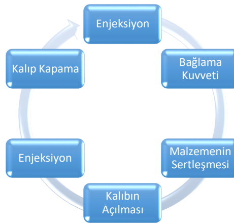
Şekil 1.8: Enjeksiyon kalıp yöntemi aşamaları
