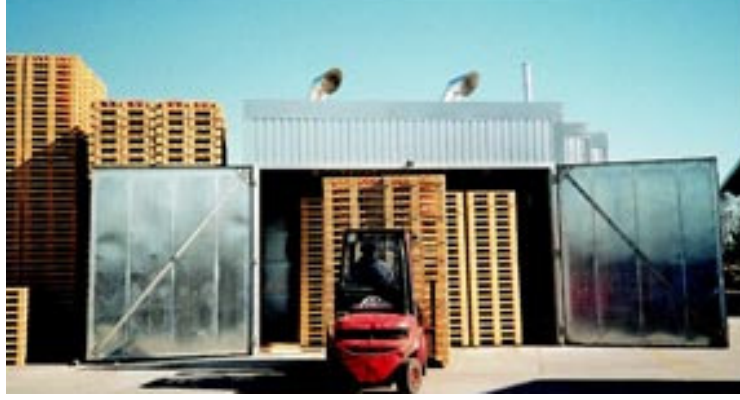
Şekil 1.7 Isıl işlemle kurutma yapan kurutma fırını (URL-9 2008).
