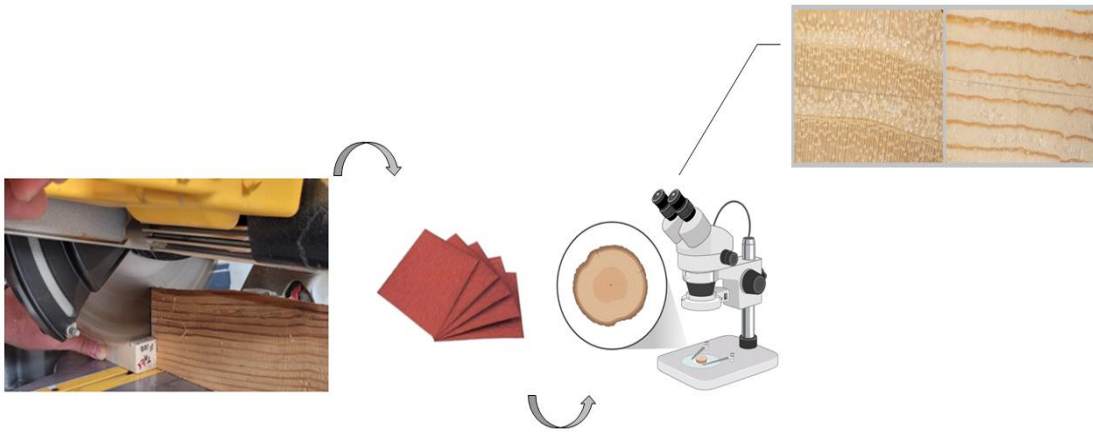
Şekil 3.11: Numunelerin hazırlanması ve ölçümü (FE ve PS türüne ait stereo mikroskop görüntüleri) (Fotoğraf: Zeynep Eda ÖZAN, 2023)
