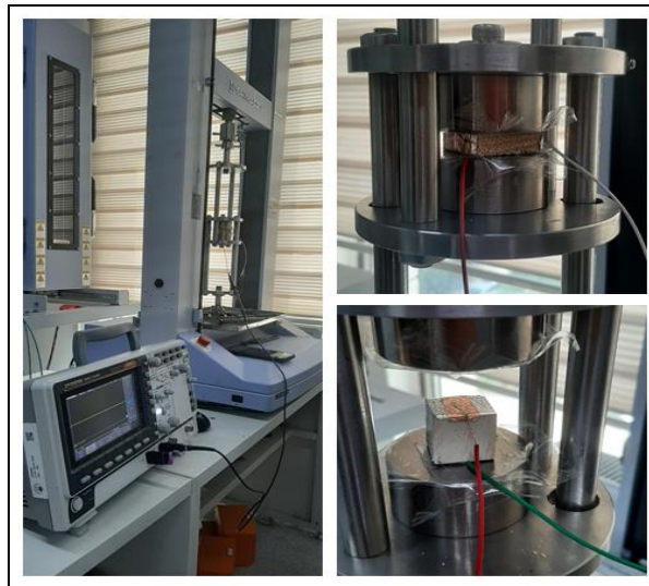
Şekil 3.5: Masif ve iletken boyalı ahşap numunelerde piezoelektrik ölçümleri (Fotoğraf: Zeynep Eda ÖZAN, 2022)
