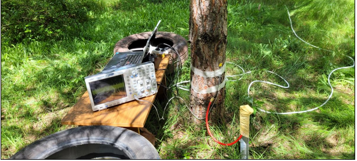
Şekil 3.17: Dikili ağaçta elektriksel potansiyel ölçüm düzeneği (Fotoğraf: Zeynep Eda ÖZAN, 2023)
