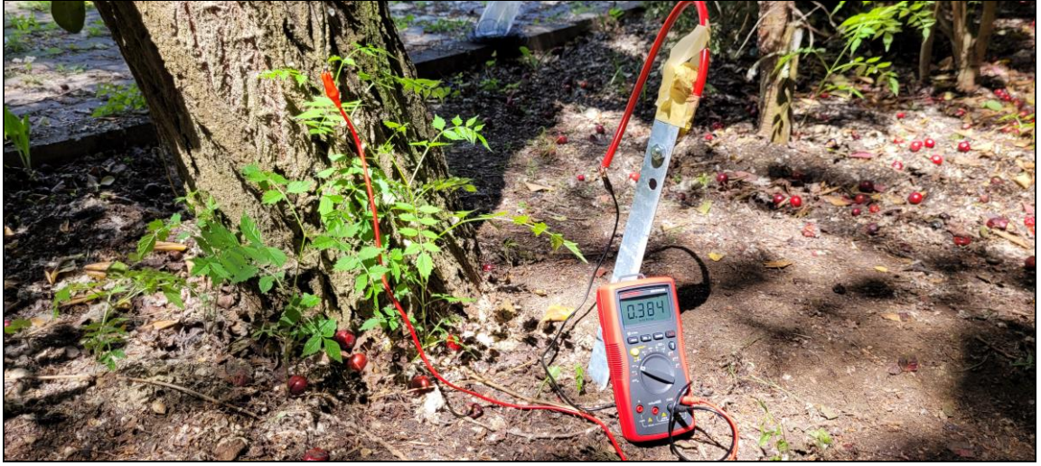
Şekil 3.15: Elektriksel potansiyel ölçümü için yapılan ön test (Fotoğraf: Zeynep Eda ÖZAN, 2023)
