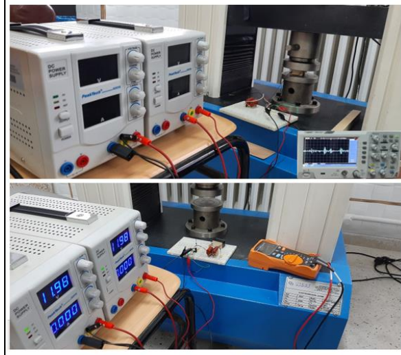
Şekil 3.4: Ahşap numunelerde piezoelektrik ölçümleri için güç kaynağı kullanımı (Fotoğraf: Zeynep Eda ÖZAN, 2022)
