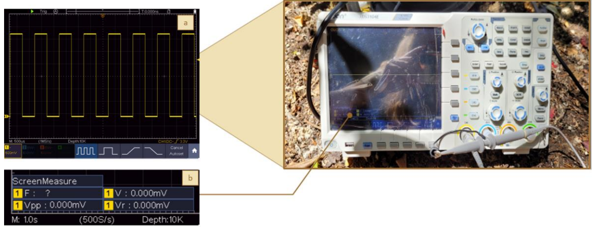
Şekil 3.18: Osiloskoba ait sinyal üretici devrenin çıkış sinyal kontrolü (a), stabilizasyonu (b) (Fotoğraf: Zeynep Eda ÖZAN, 2023)
