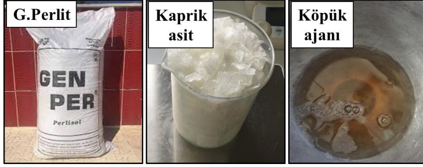
Şekil 3.1: Deneyde kullanılan malzemeler
