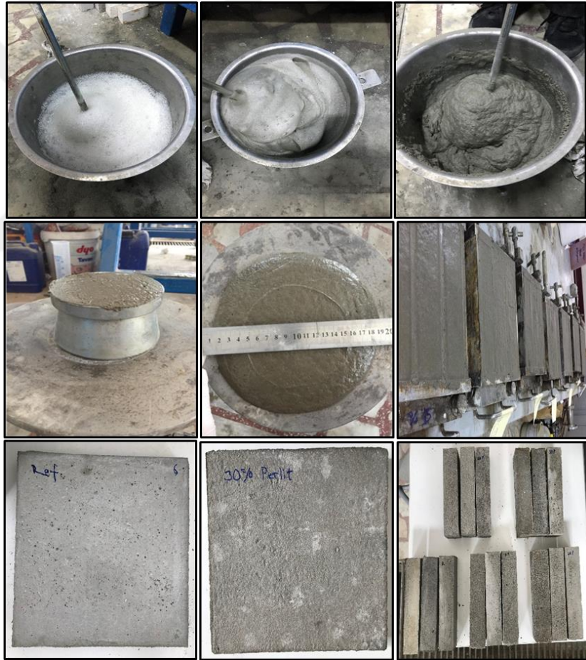
Şekil 3.4: Köpük beton numunelerin hazırlanması
