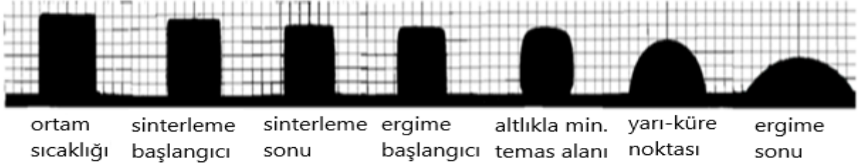
Şekil 5. Firitin ısı mikroskobu ile gözlemlenen karakteristik noktaları.
