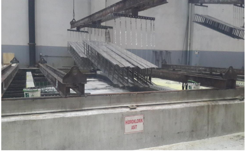
Şekil 4.16: Sıcak daldırma galvaniz HCL asit prosesi
