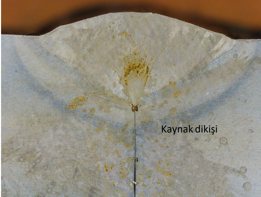
Şekil 6-10:3 Nolu Numunenin Optik mikroskop görüntüsü 5 x
