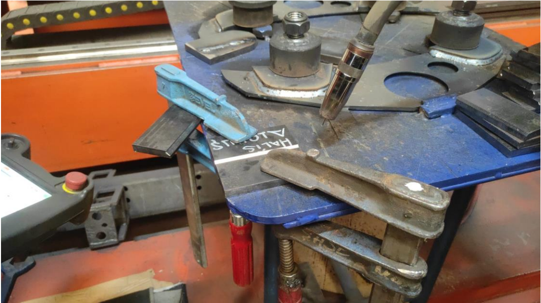
Şekil 6-3: Numunelerin Tezgaha Sabitlenerek Kaynak Torcunun Kaynak Başlangıç Noktasına Ayarlanması
