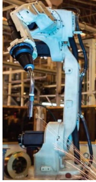
Şekil 5-4:GeKa Robot - OTC marka kaynak robotu
