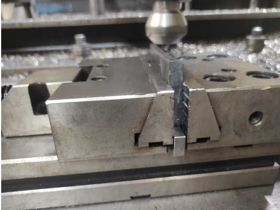
Şekil 5-2:CNC Tezgâhında Numuneye 45° Açılış İle Kaynak Ağızı Açılması
