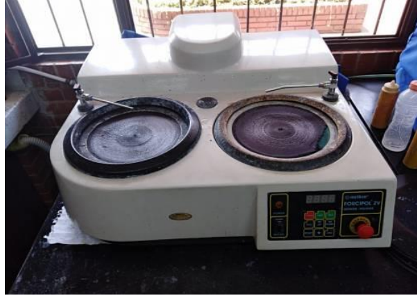
Şekil 5-5:Test numunelerinin zımparalanması için kullanılan Metkon FORCİPOL 2V
