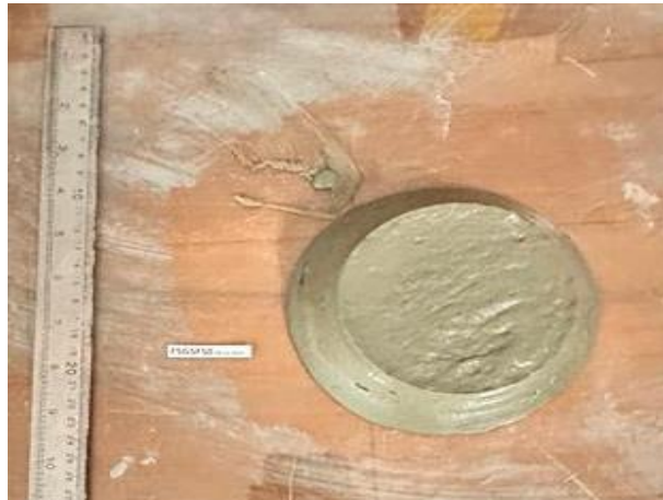
Şekil 3.10: Köpük beton karışımlarının yayılma tayini
