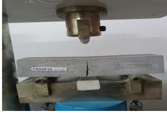
Şekil 3.12: Köpük betonların eğilme dayanımı tespiti
