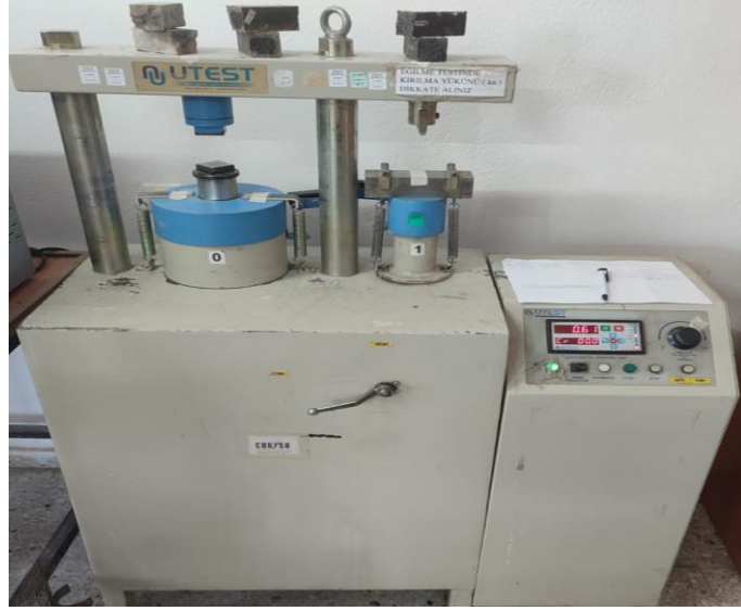
Şekil 3.11: Basınç ve eğilme dayanımı tespit cihazı
