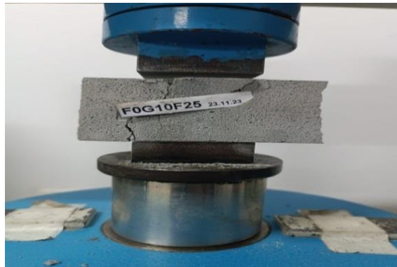
Şekil 3.13: Köpük betonların basınç dayanımı tespiti
