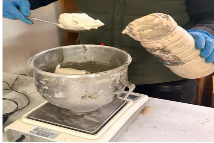
Şekil 3.6: Köpüğün ıslak karışıma ilave edilmesi
