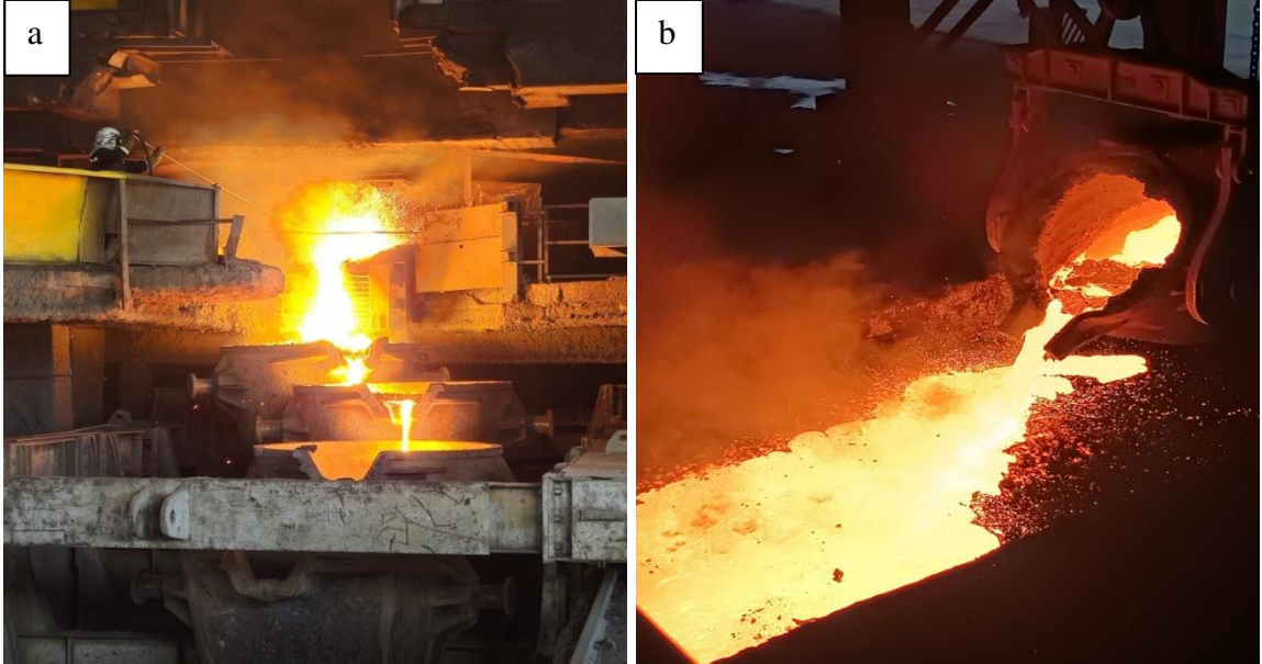
Şekil 1.4: Sıvı ferrokromun potalara aktarılması (a), potalardan kalıplara dökülmesi (b)
