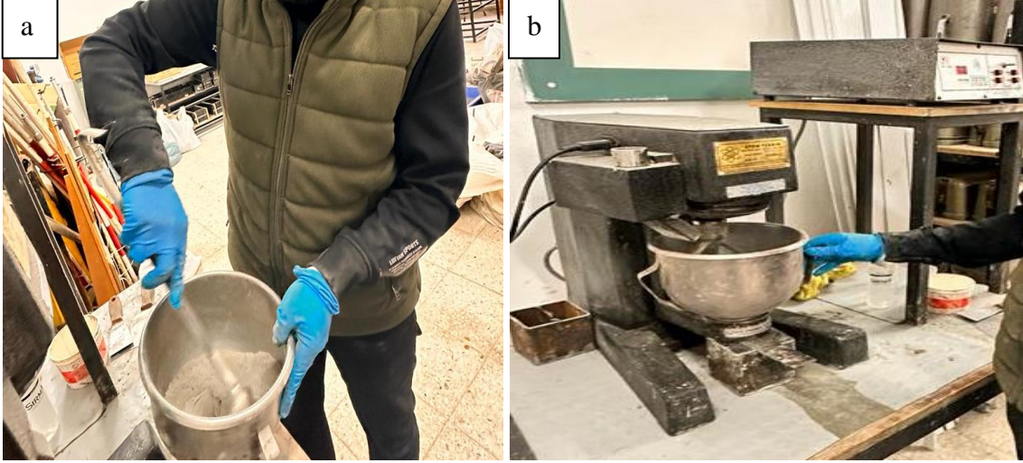
Şekil 3.4: Kuru (a) ve ıslak (b) karışım işlemi
