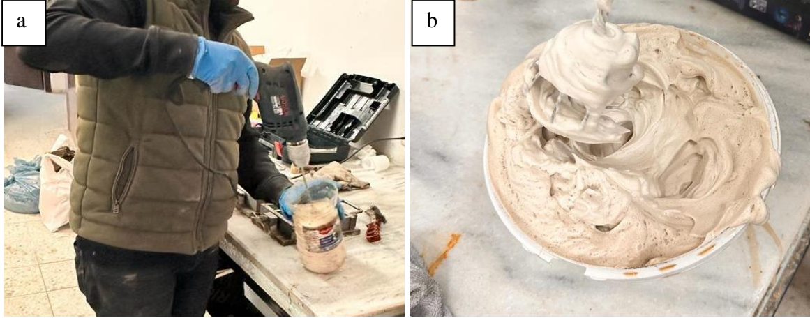
Şekil 3.5: Köpük ajanı ve suyun karıştırılması (a), köpüğün elde edilmesi (b)
