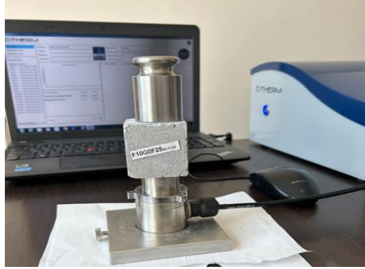
Şekil 3.16: Köpük betonların ısı iletkenlik katsayılarının tespiti
