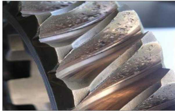
Şekil 3.11: Pitting çukurcuk oluşumu (URL-1, 2024)
