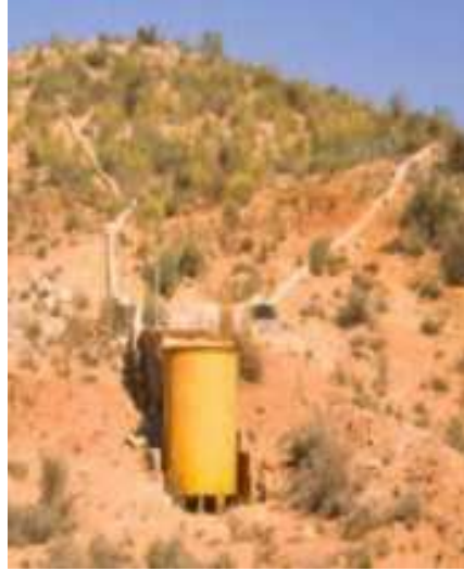
Şekil 3. Yüzeysel akış toplama alanını sırtlardan geçen su ayırma çizgilerinin sınırladığı bir yüzeysel akış parseli (Boix-Fayos et al., 2005).
