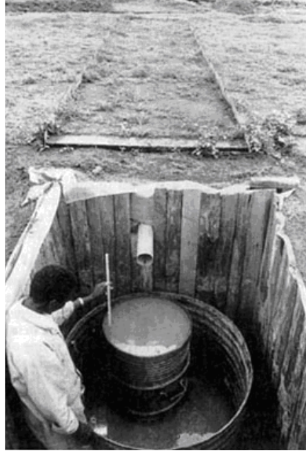
Şekil 6. Yüzeysel akışın depolanması ve ölçülmesinde iki ayrı tank kullanılması (Hudson 1993).
