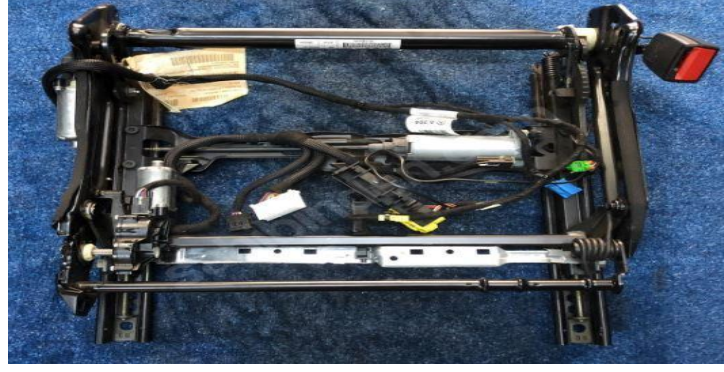
Şekil 3.2: Araç koltuk şasi tasarımı (numune ürün)
