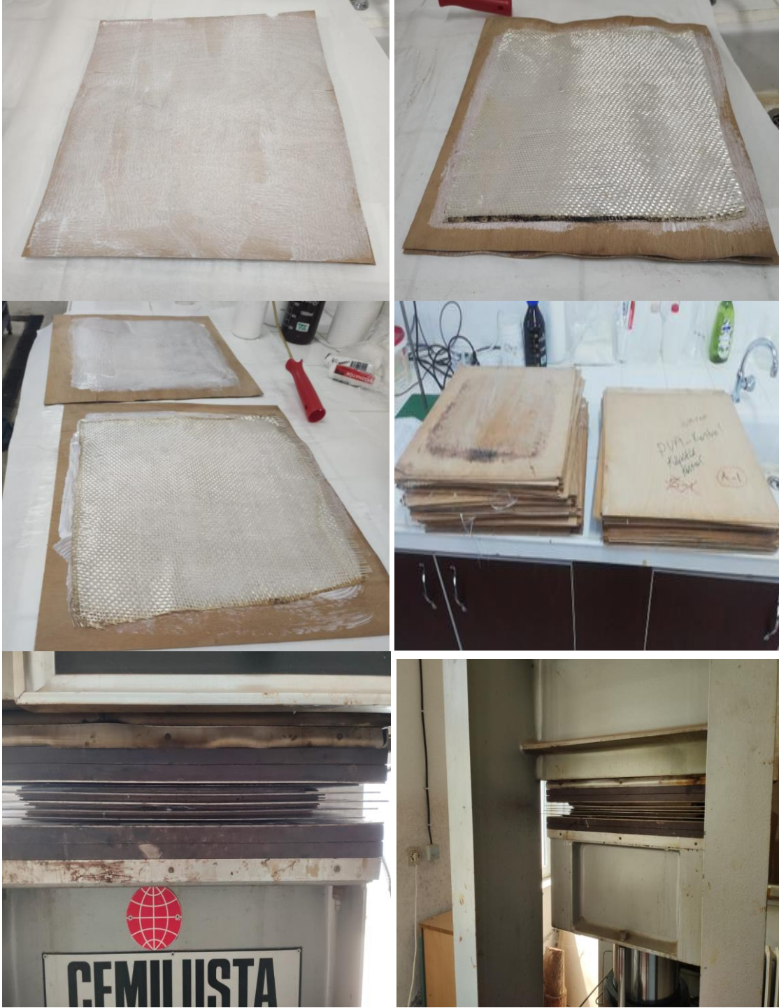
Şekil 2.3: Hazırlanan PVA tutkallarıyla kontrplakların üretilmesi ve preslenmesi
