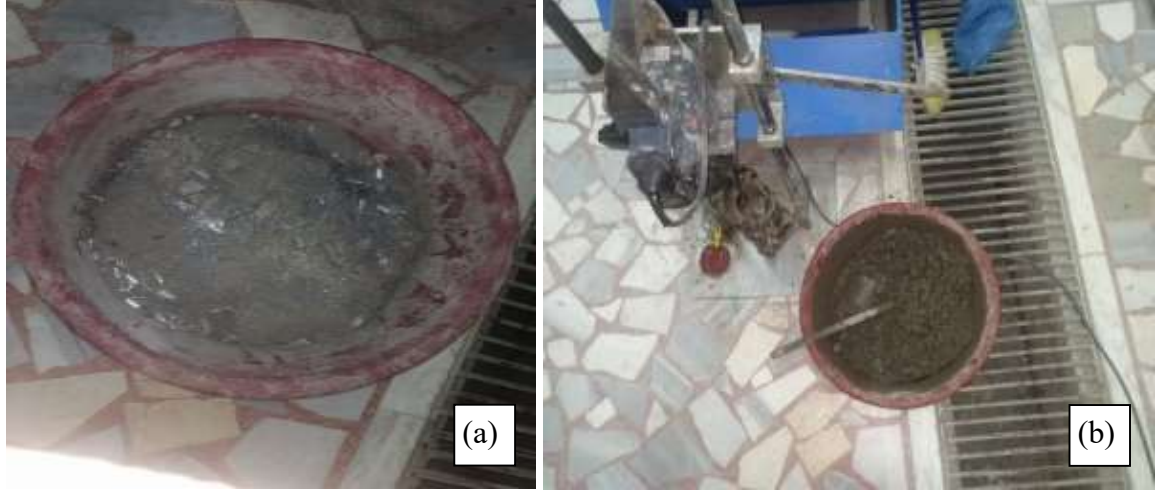
Şekil 5.5: Deney numunelerinin hazırlanması (a) Lifin agrega harmanı ile kuru olarak karıştırılması (b) Numunelerin titreşimli kompaktör ile sıkıştırılması
