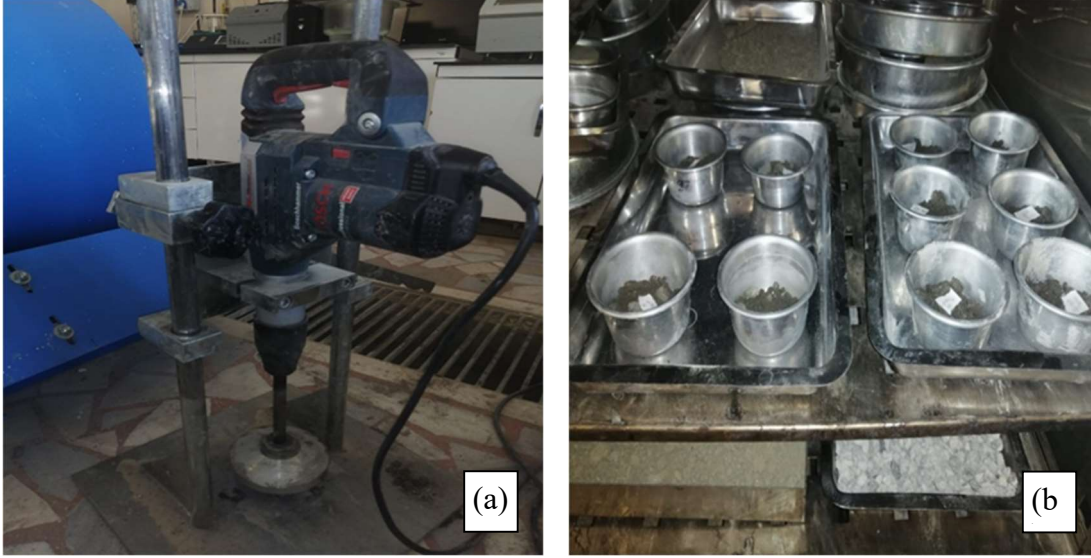
Şekil 5.4: SSB karışımların optimum su muhtevalarının belirlenmesi (a) Titreşimli kompaktör (b) Su muhtevası numuneleri
