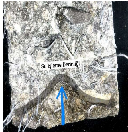
Şekil 5.11: Permeabilite deneyi numune iç yüzeyinde su işleme derinliğinin belirlenmesi
