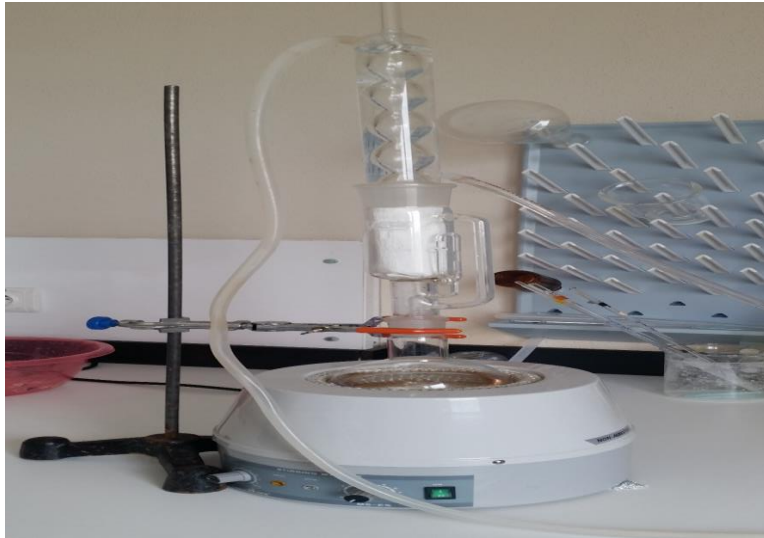
Şekil 3.1: Soxhlet cihazı ile ekstraksiyon işlemi.
