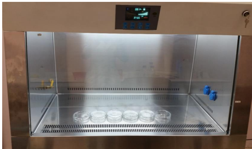
Şekil 3.3: Laminar kabin içerisinde kurumaya bırakılan ekstraktlı diskler.
