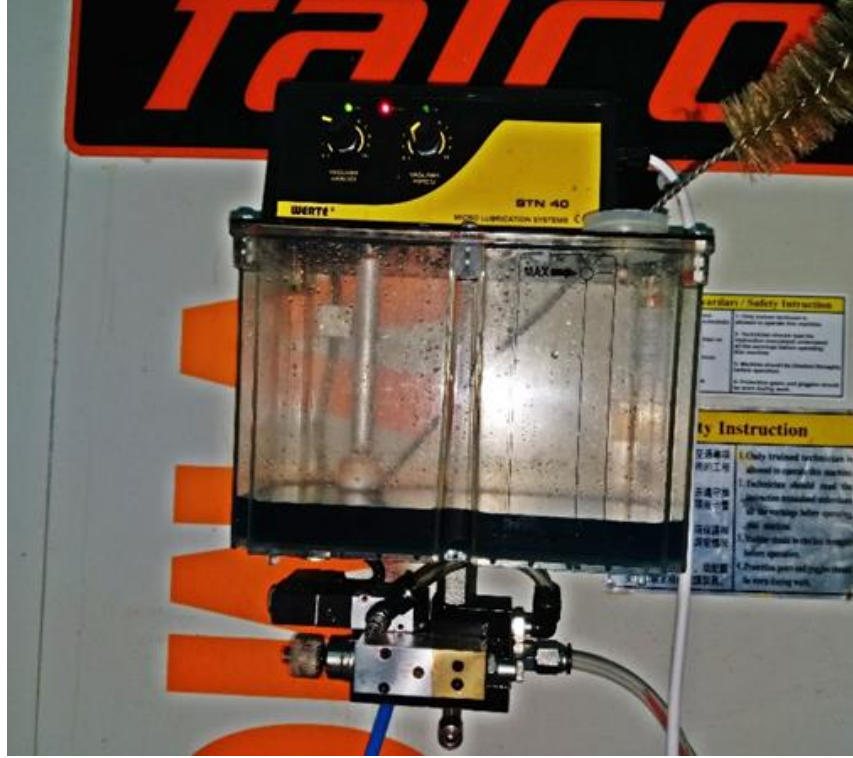
Şekil 3.3: Minimum miktarda yağlama ünitesi
