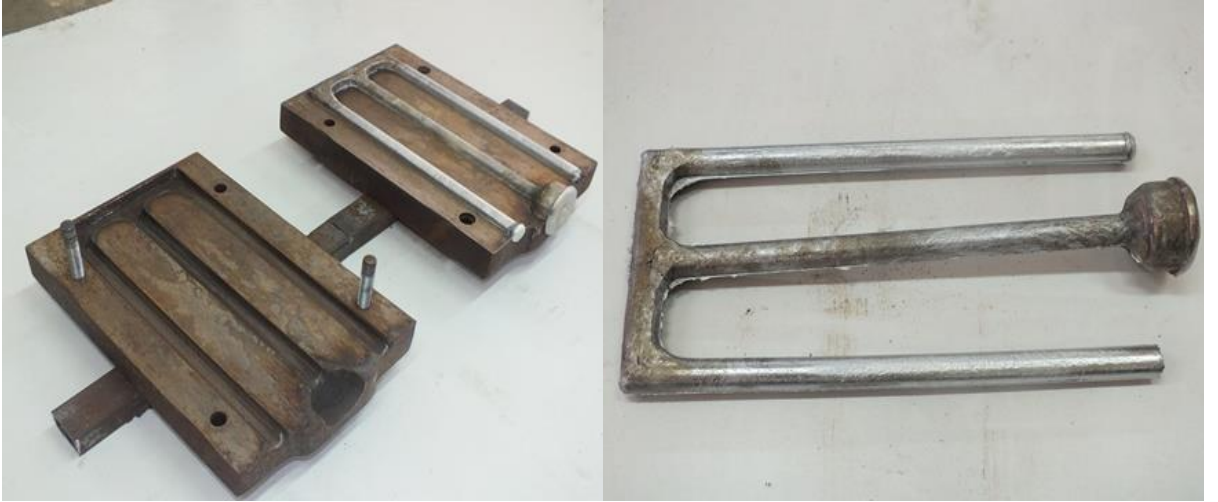
Şekil 23: Döküme hazır olan metal kalıp ve numune.
