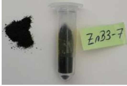
Şekil 4. 27: Güç optimizasyonunda elde edilen ZnNi_2S_4 nanopartiküllerinin kurutulduktan sonraki fotoğrafları
