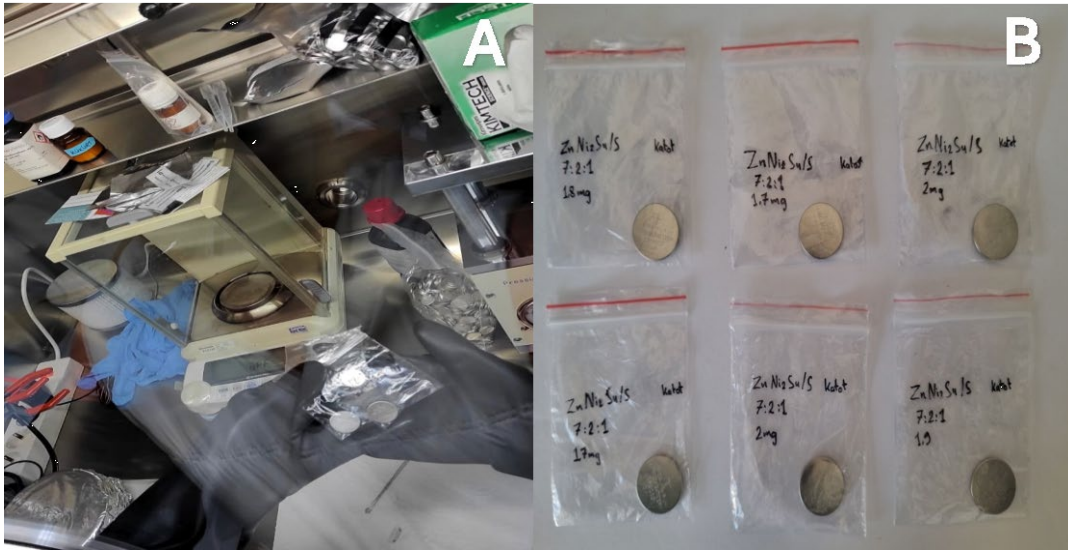
Şekil 4. 20: (A) glovebox içinde düğme pillerin hazırlanması ve (B) hazırlanan CR2032 düğme piller
