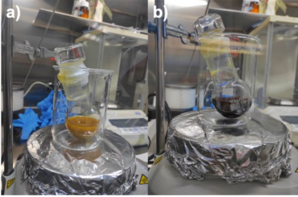
Şekil 4. 31: \text{Li}_2\text{S}_6 reaksiyon başlangıcı ve (b) reaksiyon başladıktan 24 saat sonra
