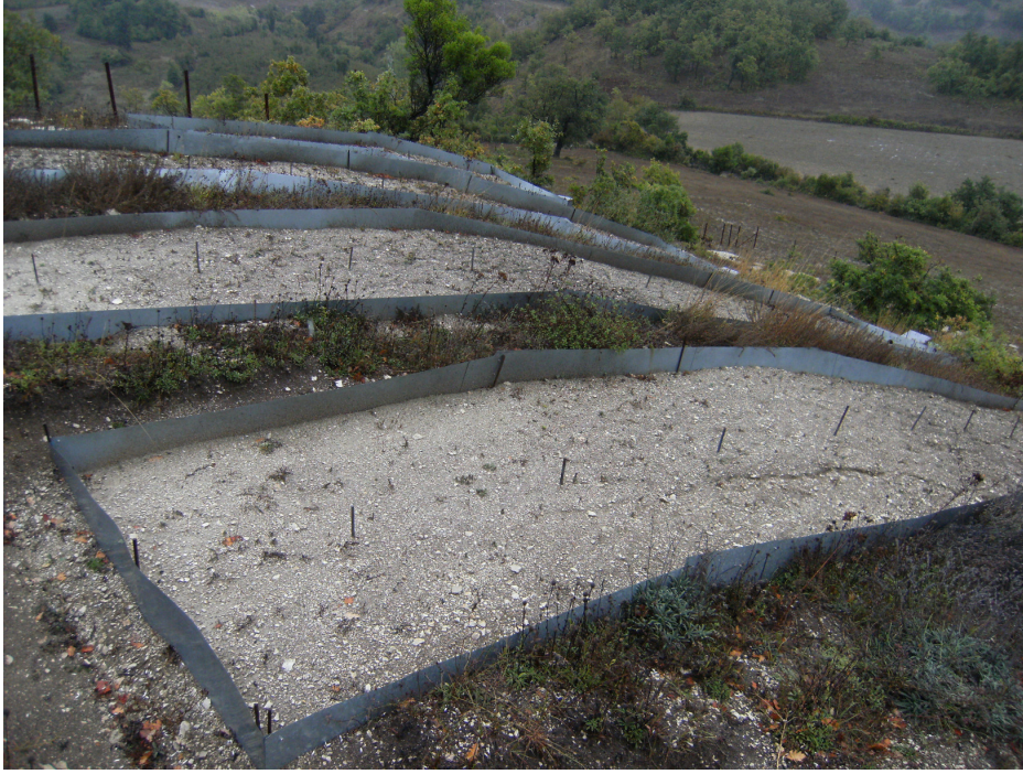
Şekil 2.10 Dışbükey parseller üzerinde yer alan seviye ölçüm çubukları (Fotoğraf: Hüseyin Şensoy 2008).
