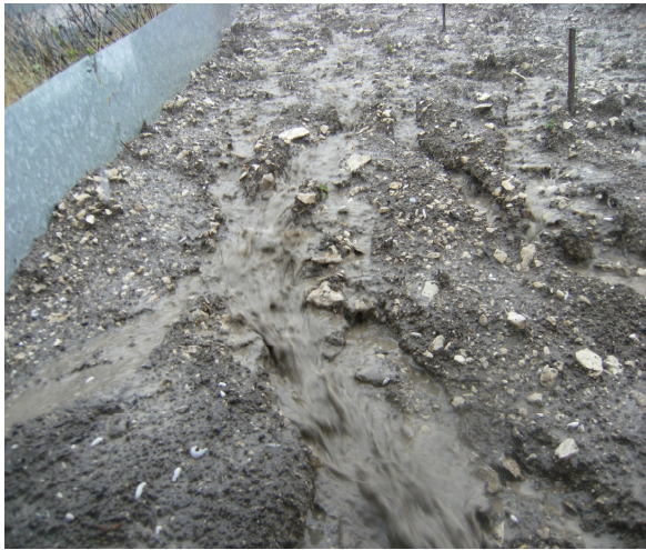
Şekil 2.13 Yüzeysel akış toplama alanında şiddetli yağmur sırasında oluşan yüzeysel akış (Fotoğraf: Hüseyin Şensoy 2009).
