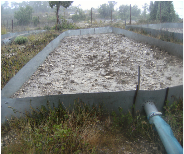
Şekil 2.13 Yüzeysel akış toplama alanında şiddetli yağmur sırasında oluşan yüzeysel akış (Fotoğraf: Hüseyin Şensoy 2009).
