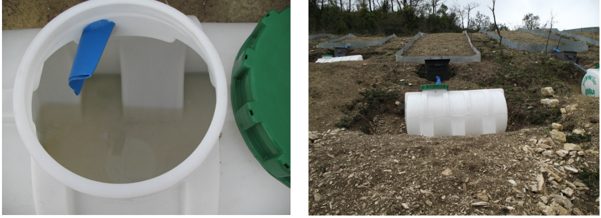
Şekil 2.9 Yüzeysel akış ve askıda sediment toplama tankı (Fotoğraf: Hüseyin Şensoy 2007).
