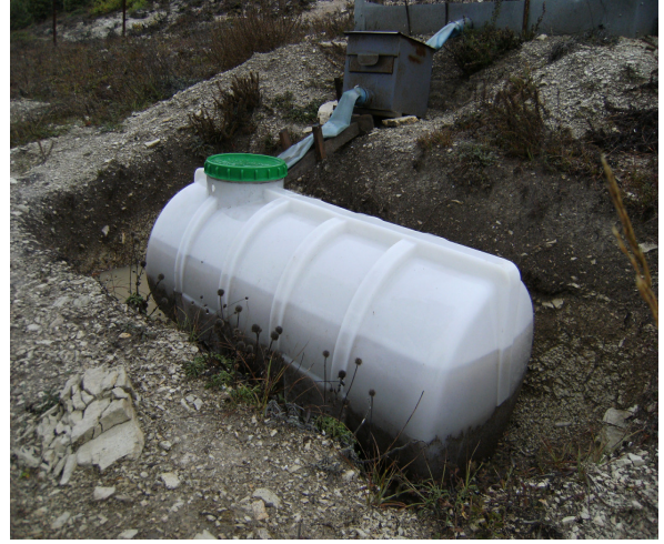
Şekil 2.12 Yüzeysel akış ve askıda sediment depolama tankında biriken yağmur suyu (Fotoğraf: Hüseyin Şensoy 2008).
