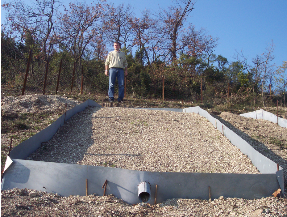
Şekil 2.5 Arazi üzerine tesis edilmiş yüzeysel akış parseli, sediment ve yüzeysel akış toplama alanı (Fotoğraf: Hüseyin Şensoy 2006).
