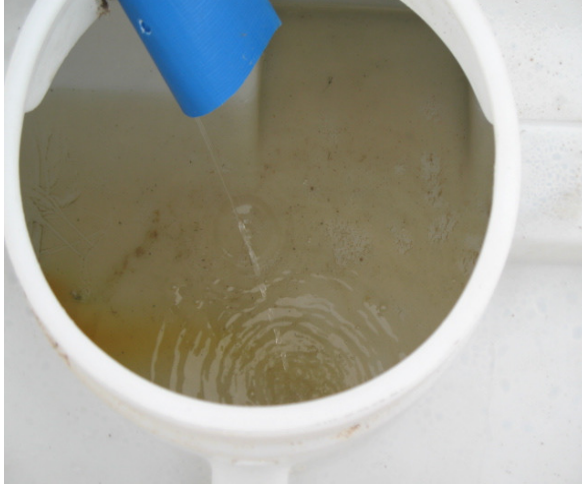
Şekil 2.12 Yüzeysel akış ve askıda sediment depolama tankında biriken yağmur suyu (Fotoğraf: Hüseyin Şensoy 2008).
