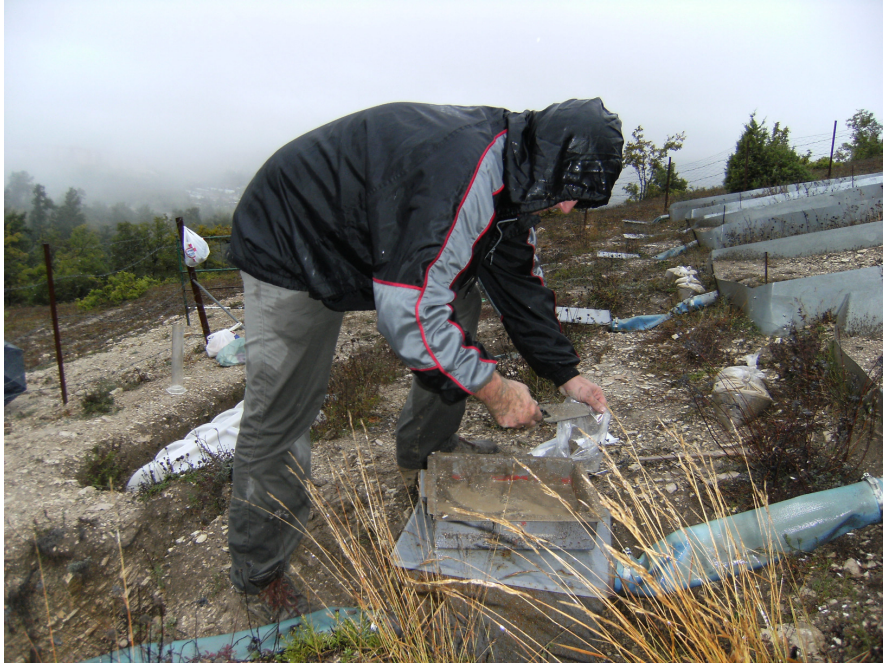
Şekil 2.11 Bir yağmur sonrasında taşınan sürüntü materyalinin poşetlenmesi (Fotoğraf: Hüseyin Şensoy 2008).
