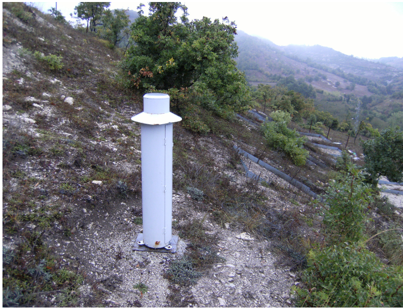
řekil 2.14 Arařtırma alanına tesis edilmiř yađıřólçer (Fotođraf: Hüseyin řensoy 2008).
