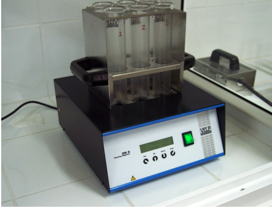
Şekil 2.14 Toprak örneklerinde Toplam N'i belirlemek amacıyla 420 °C'de 180 dakika yakma işlemi.
