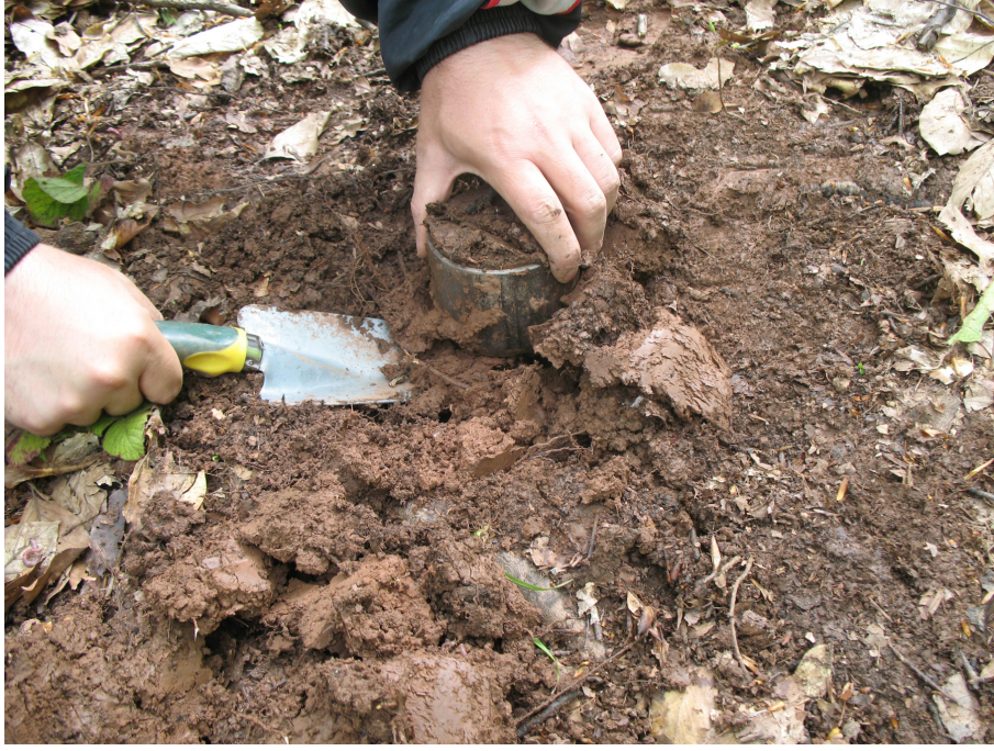
Şekil 2.9 Toprakların fiziksel ve kimyasal özelliklerini belirlemek amacıyla üst topraktan alınan hacim örnekleri.
