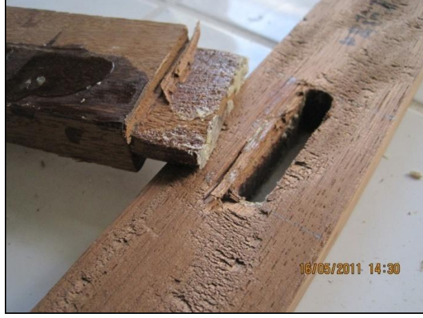
Şekil 3.11 Eğilme deneyinde irocco türü TW örneklerinin kırılma tipi (Foto: M.ZOR 2011).
