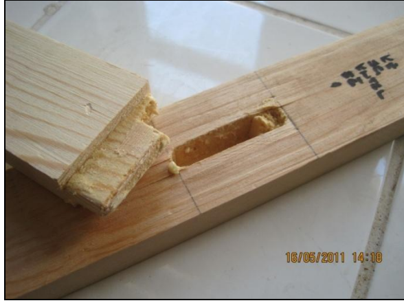
Şekil 3.6 Eğilme deneyinde sarıçam türü kontrol örneklerinin kırılma tipi (Foto: M.ZOR 2011).
