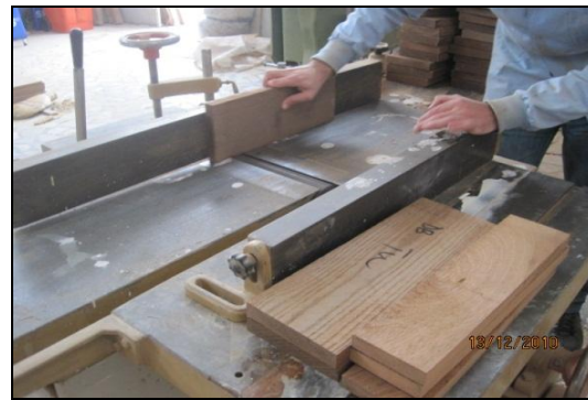
Şekil 2.8 Örneklere yüz-cumba açılması (Foto: M.ZOR 2011).
