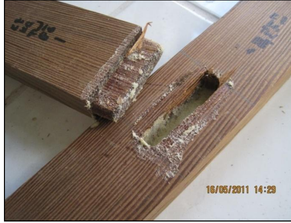
Şekil 3.14 Eğilme deneyinde karaçam türü TW örneklerinin kırılma tipi (Foto: M.ZOR 2011).
