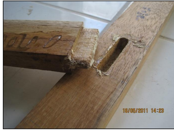
Şekil 3.10 Eğilme deneyinde ırocco türü kontrol örneklerinin kırılma tipi (Foto: M.ZOR 2011).
