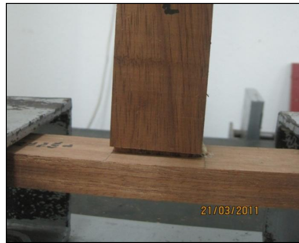
Şekil 3.44 Çekme deneyinde irocco türü TW örneklerinin kırılma tipi (Foto: M.ZOR 2011).
