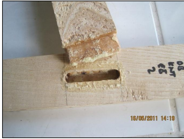
Şekil 3.7 Eğilme deneyinde dişbudak türü kontrol örneklerinin kırılma tipi (Foto: M.ZOR 2011).
