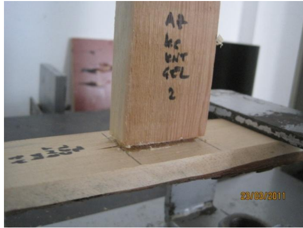
Şekil 3.38 Çekme deneyinde karaçam türü kontrol örneklerinin kırılma tipi (Foto: M.ZOR 2011).
