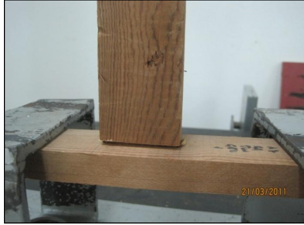
Şekil 3.42 Çekme deneyinde sarıçam türü TW örneklerinin kırılma tipi (Foto: M.ZOR 2011).
