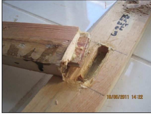
Şekil 3.9 Eğilme deneyinde karaçam türü kontrol örneklerinin kırılma tipi (Foto: M.ZOR 2011).
