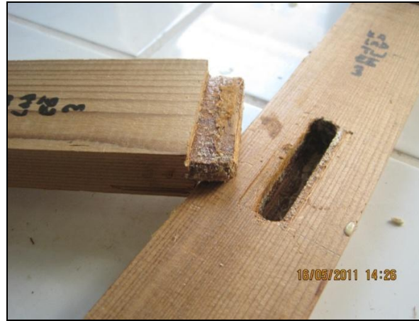
Şekil 3.13 Eğilme deneyinde doğu ladini türü TW örneklerinin kırılma tipi (Foto: M.ZOR 2011).
