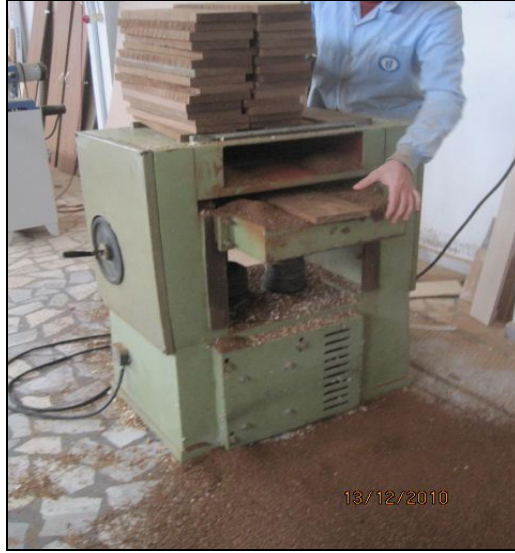
Şekil 2.9 Örnek kalınlıklarının ayarlanması (Foto: M.ZOR 2011).
