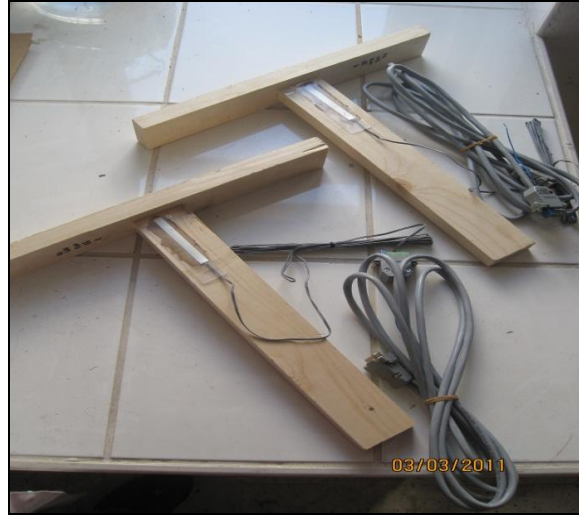
Şekil 2.15 Numune üzerine yapıştırılan Gerinim Pulları (Foto: M.ZOR 2011).
