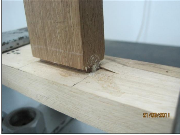
Şekil 3.37 Çekme deneyinde ırocco türü kontrol örneklerinin kırılma tipi (Foto: M.ZOR 2011).
