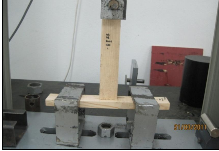
Şekil 2.26 Çekme direnci deney düzeneği (Foto: M.ZOR 2011).
