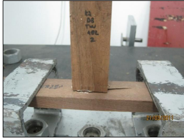
Şekil 3.43 Çekme deneyinde dişbudak türü TW örneklerinin kırılma tipi (Foto: M.ZOR 2011).
