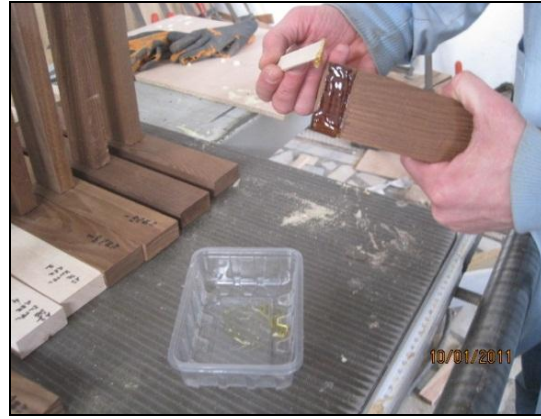
Şekil 2.13 Örneklere tutkal sürülmesi (Foto: M.ZOR 2011).
