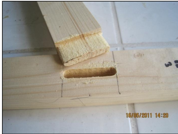
Şekil 3.8 Eğilme deneyinde doğu ladini türü kontrol örneklerinin kırılma tipi (Foto: M.ZOR 2011).
