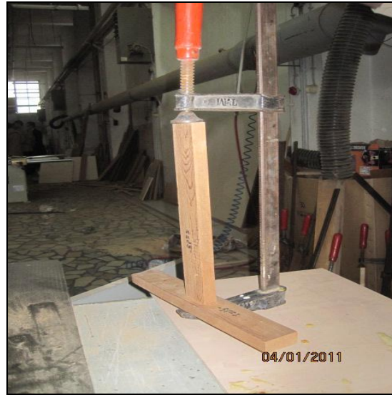
Şekil 2.14 Örneklerin mengene ile sıkıştırılması (Foto: M.ZOR 2011).
