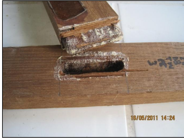
Şekil 3.15 Eğilme deneyinde dişbudak türü TW örneklerinin kırılma tipi (Foto: M.ZOR 2011).
