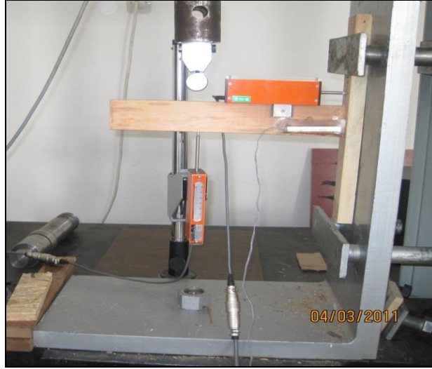
Şekil 2.18 LVDT ve gerinim pulunun eğilme deneyine tabi tutulması (Foto: M.ZOR 2011).
