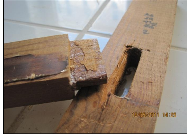
Şekil 3.12 Eğilme deneyinde sarıçam türü TW örneklerinin kırılma tipi (Foto: M.ZOR 2011).
