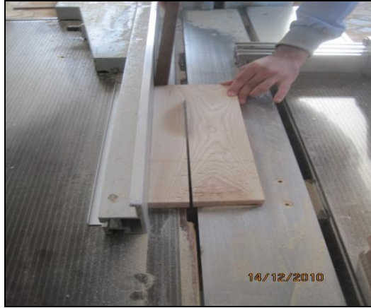
Şekil 2.10 Örneklere boy ölçülendirmesi yapılması (Foto: M.ZOR 2011).
