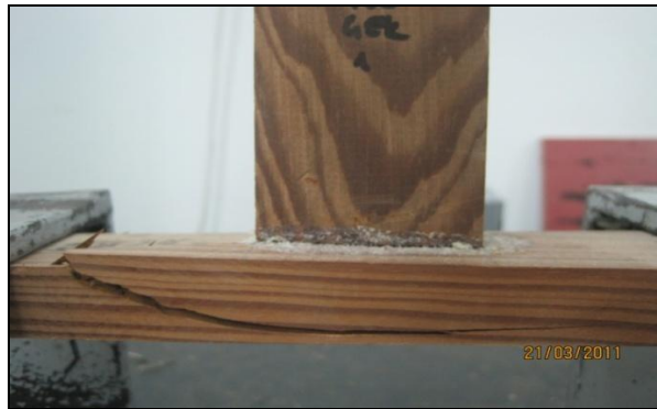
Şekil 3.41 Çekme deneyinde karaçam türü TW örneklerinin kırılma tipi (Foto: M.ZOR 2011).
