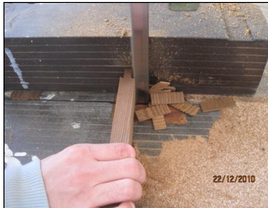
Şekil 2.11 Örneklerin lamba genişliklerinin açılması (Foto: M.ZOR 2011).
