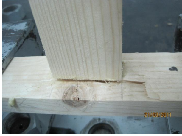
Şekil 3.36 Çekme deneyinde doğu ladini türü kontrol örneklerinin kırılma tipi (Foto: M.ZOR 2011).
