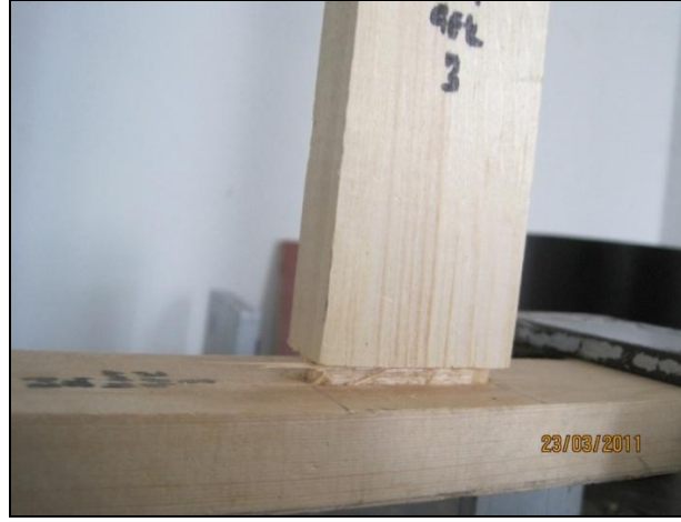
Şekil 3.39 Çekme deneyinde sarıçam türü kontrol örneklerinin kırılma tipi (Foto: M.ZOR 2011).
