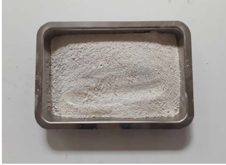
Şekil 3. 6: Karışımda kullanılan kolemanit.
