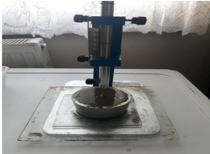
Şekil 3. 12: Vicat deneyi priz sona erme süresi tayini.
