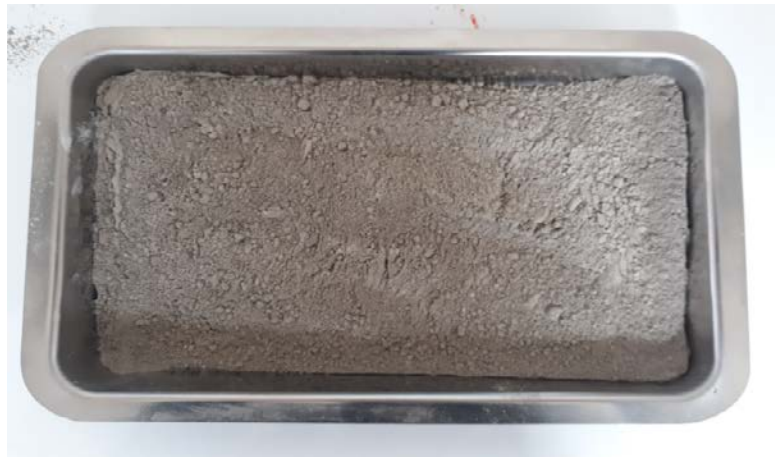
Şekil 3. 3: Karışımında kullanılan uçucu kül.
