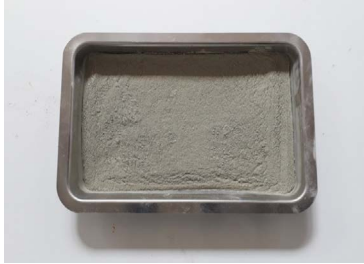
Şekil 3. 8: Karışımda kullanılan kolemanit konsantratör atığı.
