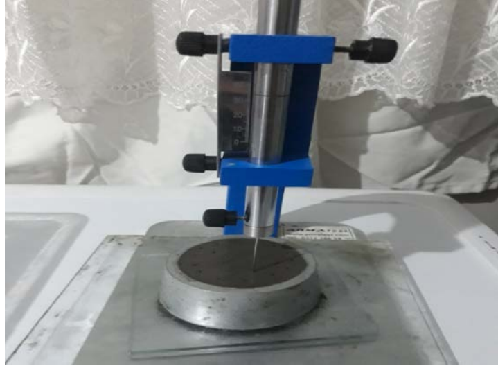
Şekil 3. 11: Vicat deneyi priz başlama süresi tayini.
