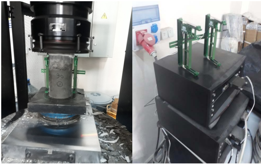
Şekil 3. 24: Ekstansometre ve kullanımı.
