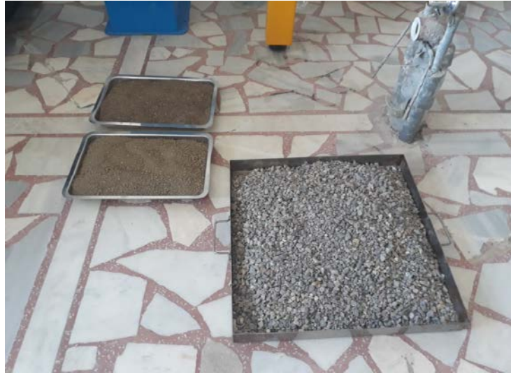
Şekil 3. 2: Karışımında kullanılan iri agregası-kırma kum- dere kumu.
