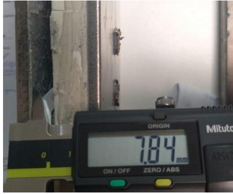
Şekil 4.11: Düz geometrideki açıklık ölçüsü
