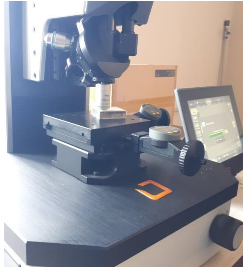
Şekil 3.11: Seramik numuneye sertlik testi uygulaması
