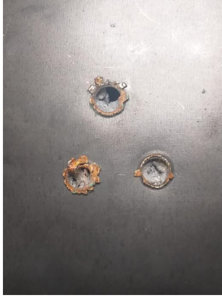
Şekil 4.8: Merminin yuvarlak şekilli zırha giriş görüntüsü
