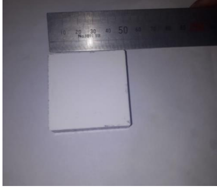
Şekil 4.1: Presleme sonrası düz şekilli alümina numune
