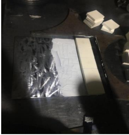
Şekil 3.12: 2 Farklı alümina numunelerin saca yapıştırılması
