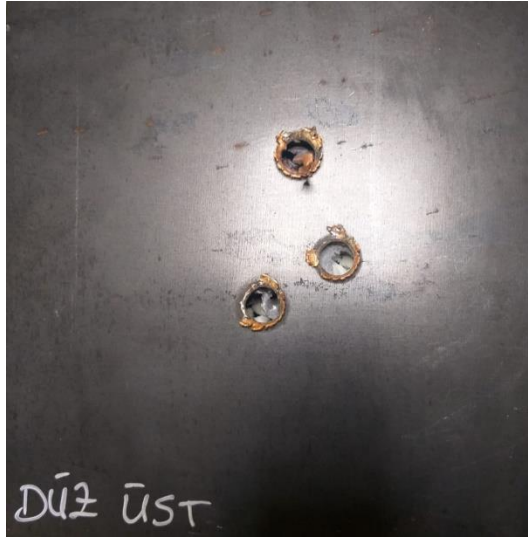
Şekil 4.9: Merminin düz şekilli zırha giriş görüntüsü
