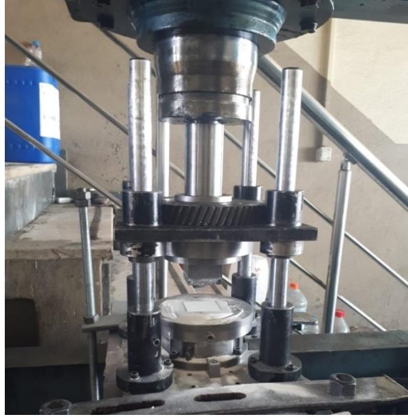
Şekil 3.8: Kalıpların prese bağlanması hali
