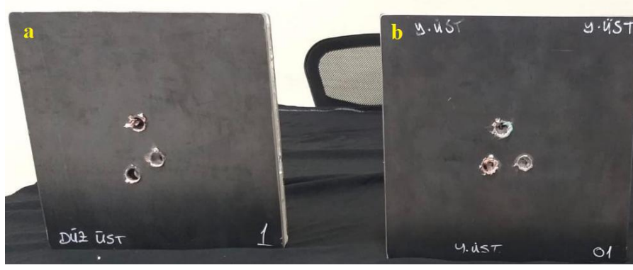
Şekil 4.6: Zırh numunelerine ateş edildikten sonra ön görüntüsü a)Düz geometrili seramik zırh b)Yuvarlak geometrili seramik zırh
