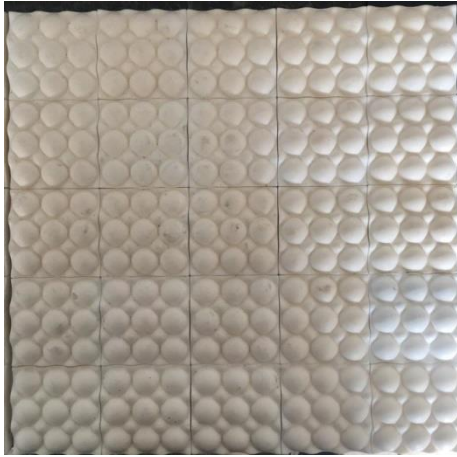
Şekil 3.13: Alümina numunelerin tek saca yapıştırılmış hali
