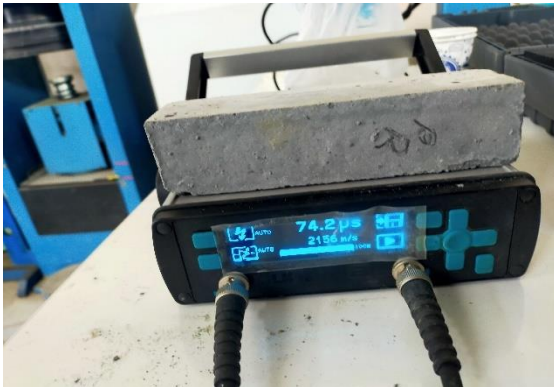
c) Ultrasonik Ses Geçiş Hızı Testi
