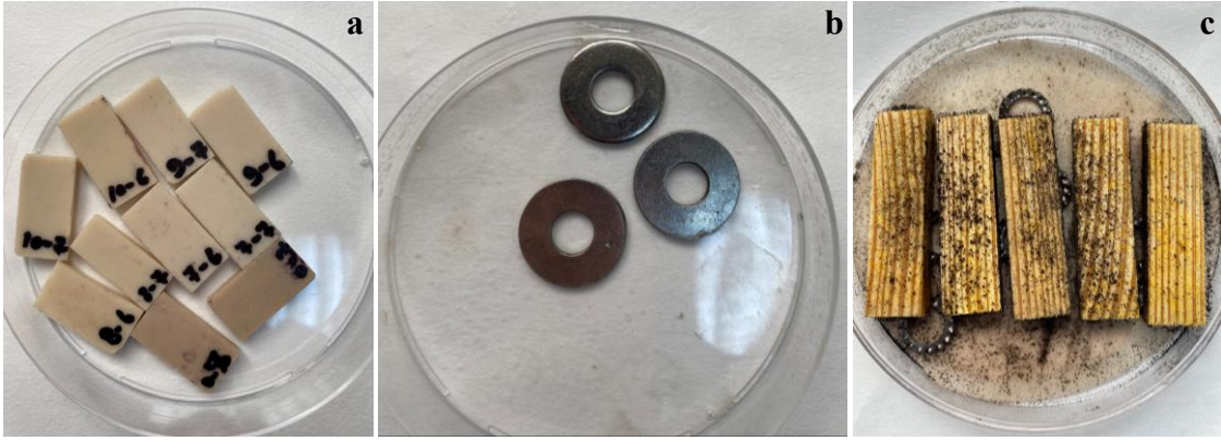
Şekil 4.61: Kontrol örnekleri; a: mantar sporu ile muamele edilmemiş saf PHB ve kompozitler, b: metal pullar, c: mantar sporlarına maruz kalmış Sarıçam örnekleri (Fotoğraf: Gülyaz AL, 2023)
