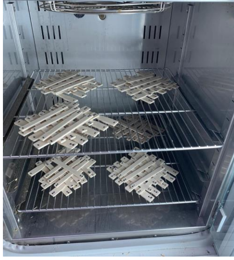
Şekil 3.6: İklimlendirme cihazında bekletilen örnekler (Fotoğraf: Gülyaz AL, 2021)
