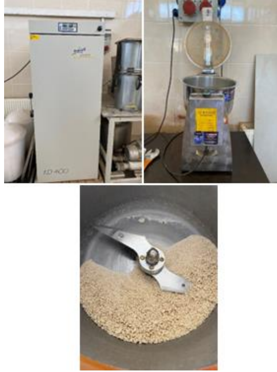
Şekil 3.4: Ekstrüderden çıkan numunelerin öğütülmesi (Fotoğraf: Gülyaz AL, 2021)
