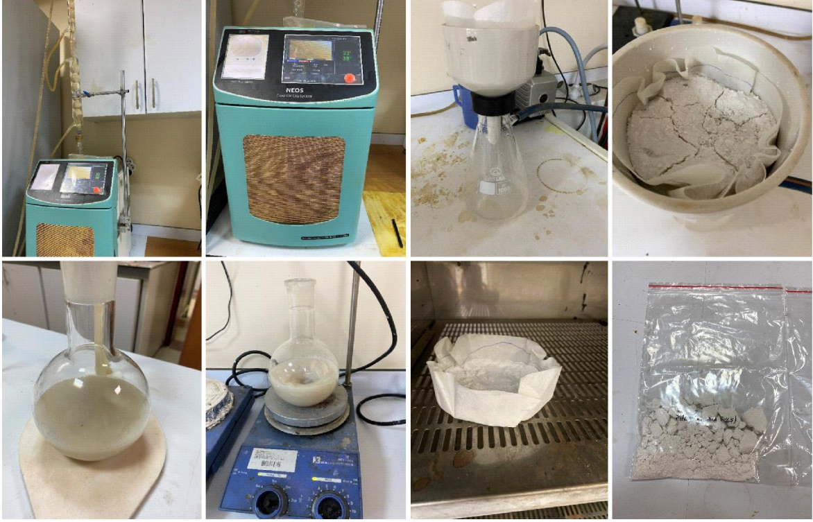
Şekil 3.1: Mikrodalga yöntemi (Fotoğraf: Gülyaz AL, 2021)
