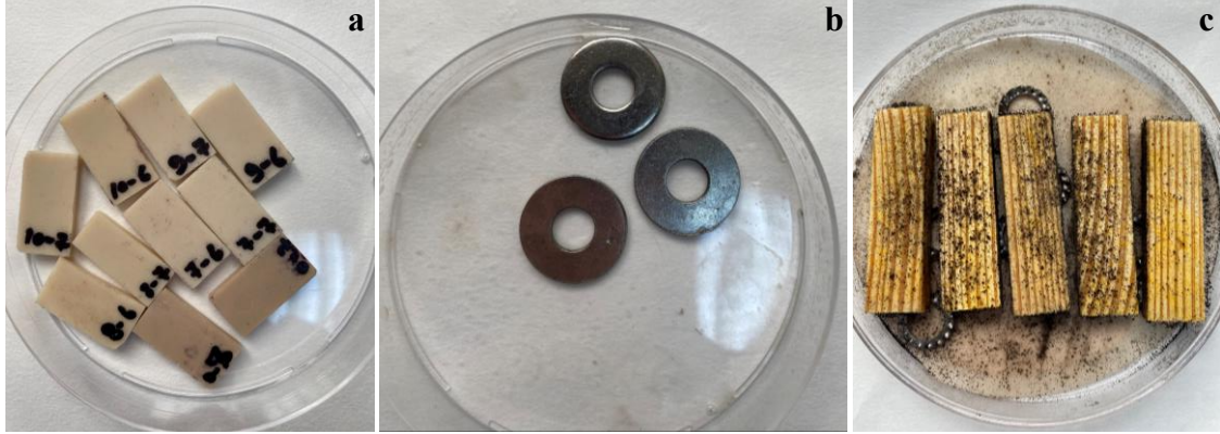
Şekil 4.26: Kontrol örnekleri; a: mantar sporu ile muamele edilmemiş örnekler, b: metal pullar, c: mantar sporlarına maruz kalmış Sarıçam örnekleri (Fotoğraf: Gülyaz AL, 2023)
