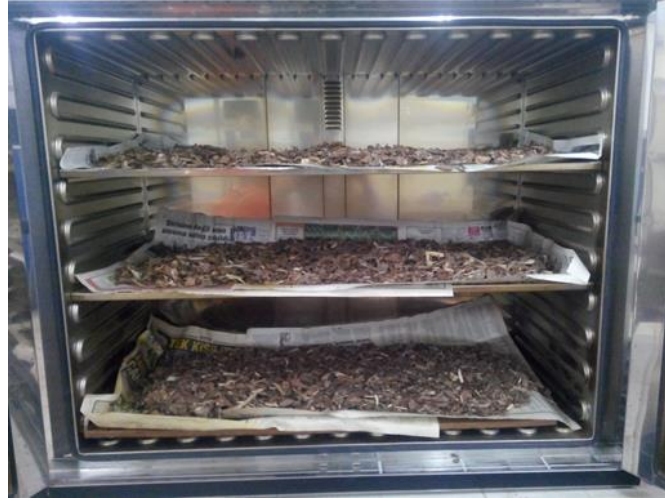
Şekil 2.9: Kabukların kurutma fırınında uygun rutubete getirilmesi
