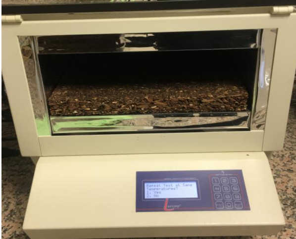
Şekil 2.17: Lasercomp Fox-314 ısı iletkenlik ölçüm cihazı (a), deney numuneleri (b)
