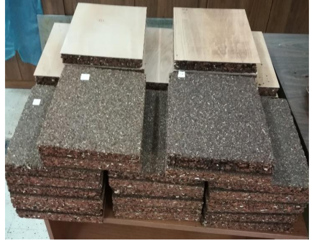
Şekil 2.17: Lasercomp Fox-314 ısı iletkenlik ölçüm cihazı (a), deney numuneleri (b)
