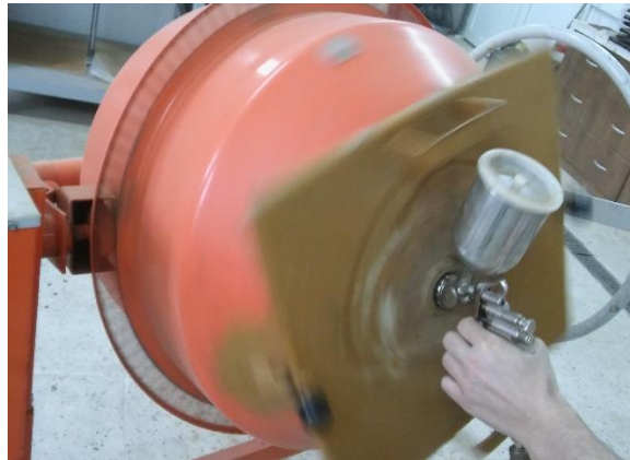
Şekil 2.12: Kabuk yongaların tutkallama işlemi
