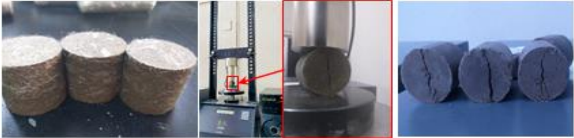
Şekil 4.10: Dolaylı çekme dayanımı deneyi uygulanması
