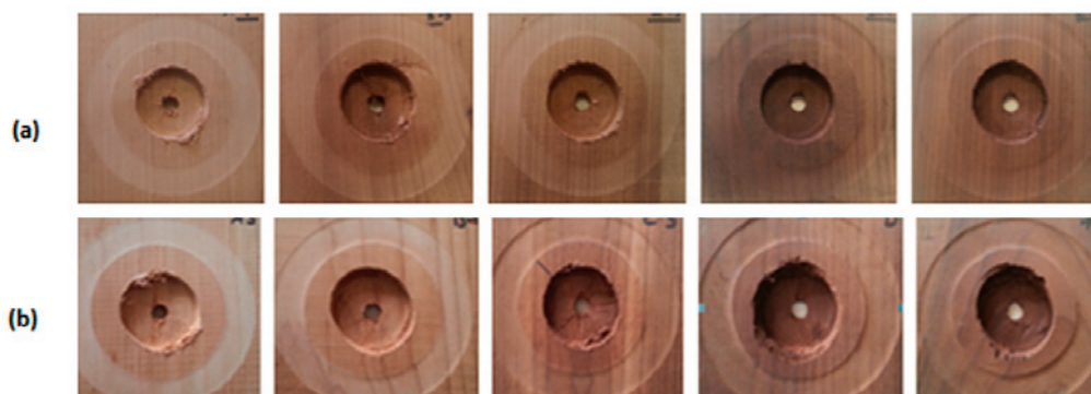
Figure 1 Images of specimens after the experiment: (a) radial specimens; (b) tangential specimens Slika 1. Fotografije uzoraka nakon eksperimenta: a) radijalni uzorci, b) tangencijalni uzorci
