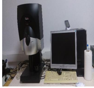
Şekil 3.9: Opaklık, parlaklık test cihazı (Fotoğraf: Ceyda HATIL, 2018).
