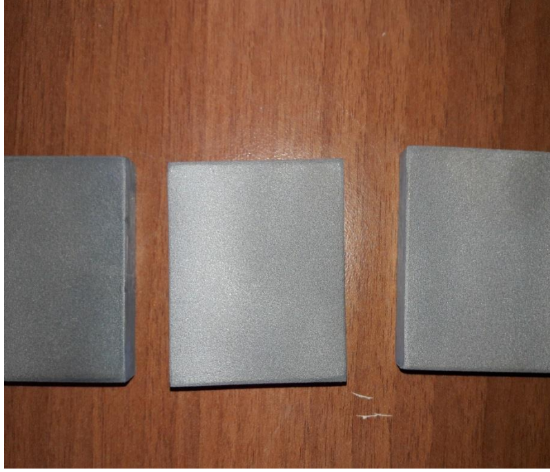
Şekil 6.6: 100 Mikron NiCrAlY kaplama tozu üzerine yapılmış olan 200 mikronluk Mo kaplama.
