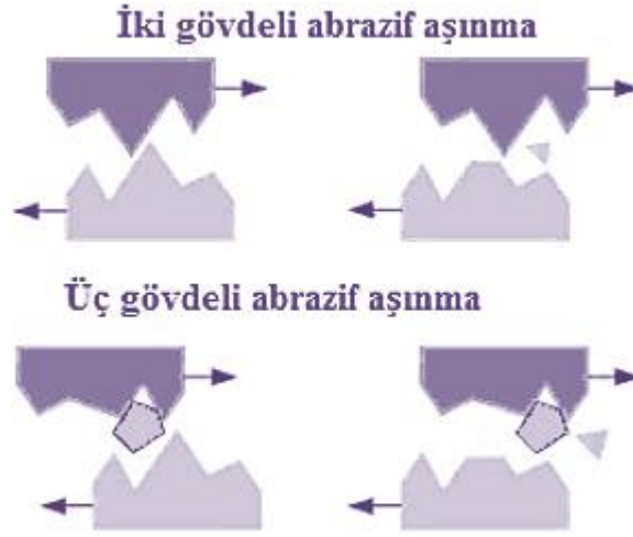
Şekil 4.3: İki farklı tip mazlemenin aşınması ve üç farklı tipteki mazlemede meydana gelen abrazif aşınma mekanizması (Liu vd., 2016).
