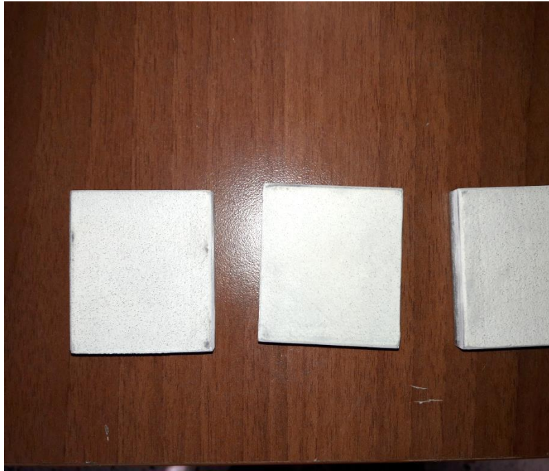
Şekil 6.5: 100 Mikron NiCrAlY kaplama tozu üzerine yapılmış olan 200 mikronluk \text{ZrO}_2 kaplama.
