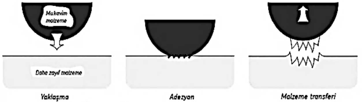
Şekil 4.7: Adhezif aşınma mekanizması (Biçer, 2015).
