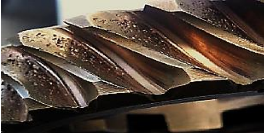
Şekil 4.9: Dişli parçalarda meydana gelen yorulma aşınması (Teber, 2015).
