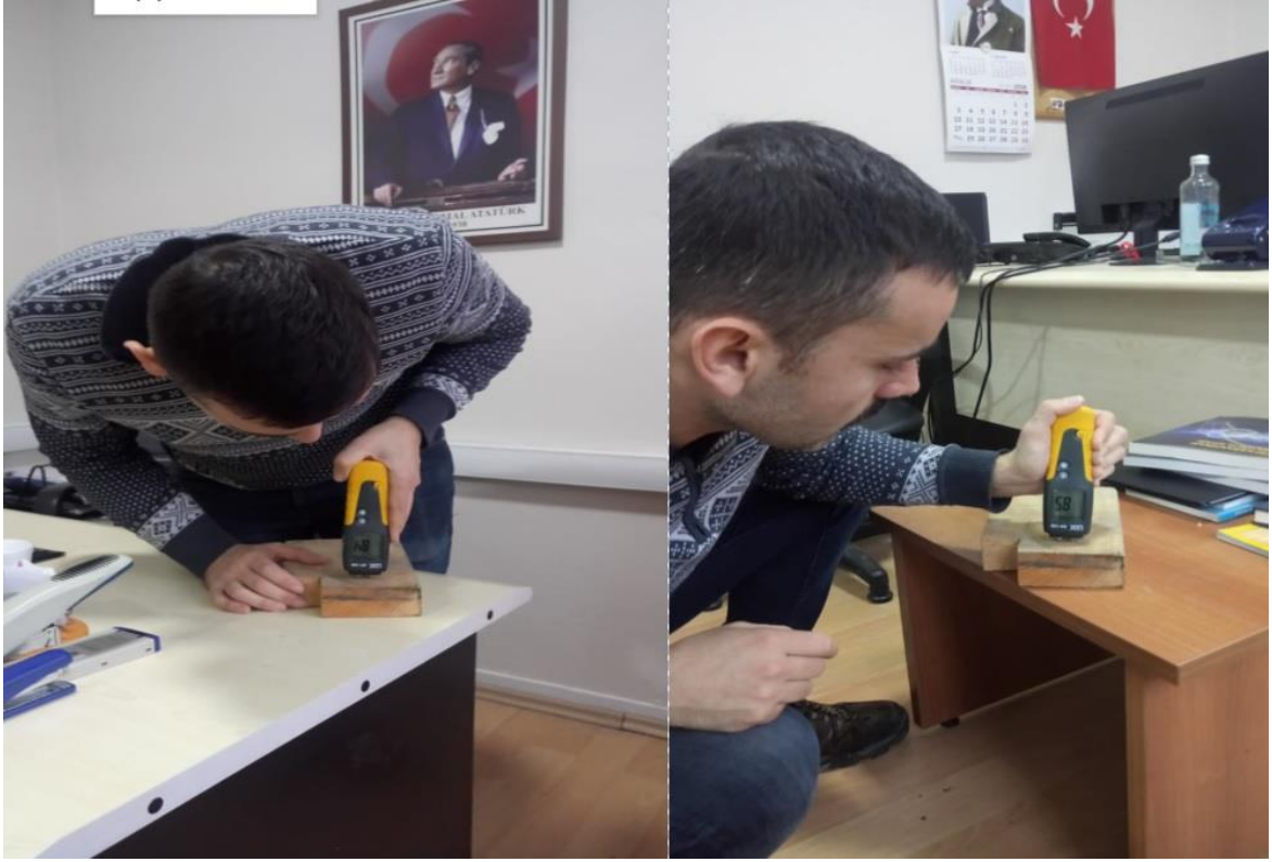
Şekil 4.4: Nemölçer ile ahşap nemi ölçümü (Fotoğraflar: Ertan ALBAS)
