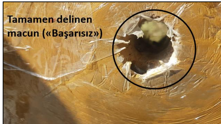
Şekil 3.5: Atış sonrası tamamen delinen macunun görünümü
