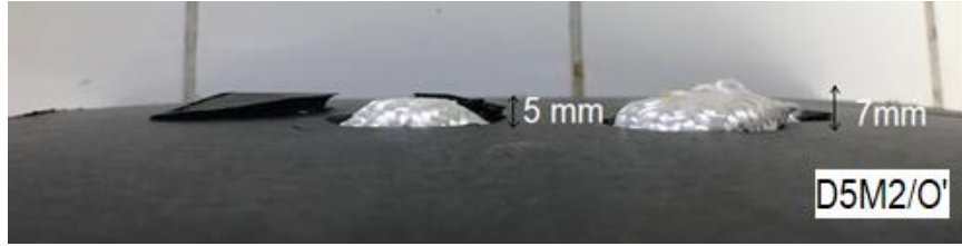
Şekil 3.26: D5M2/O panelinin arka yüzeyinde meydana gelen deformasyon derinliği.
