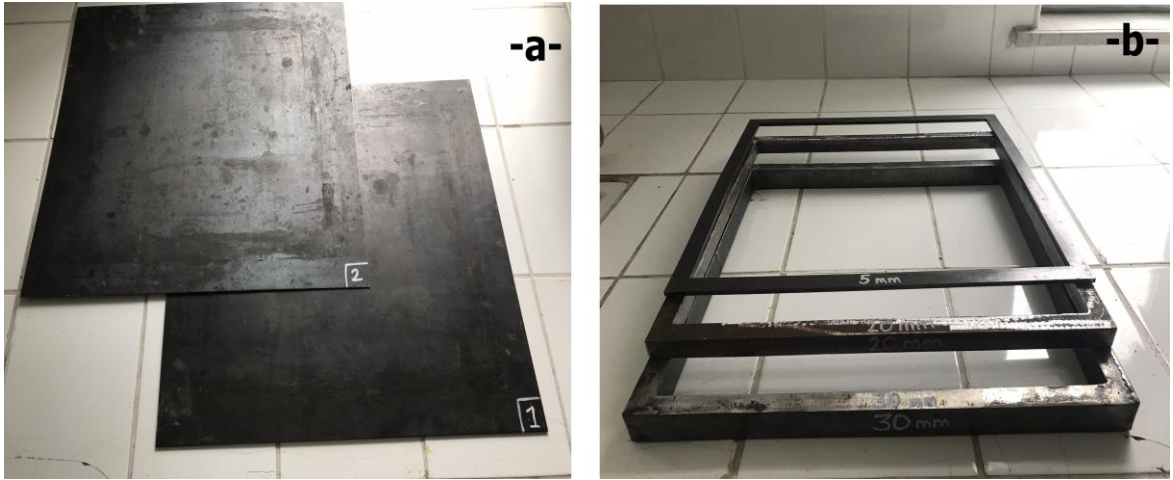
Şekil 2.10: 500x500x3 mm ebatlarında demir saçlar (a) ve 400x400x5, 20, 30 mm ebatlarındaki demir kalıplar (b).
