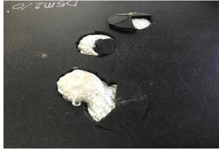
Şekil 3.29: D5M2/O panelinin arka yüzeyinde oluşan deformasyon şekilleri.
