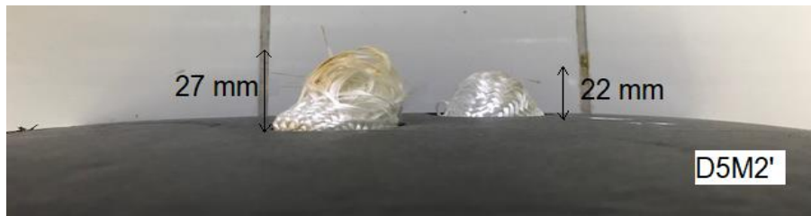
Şekil 3.24: D5M2 panelinin arka yüzeyinde meydana gelen deformasyon derinliği.
