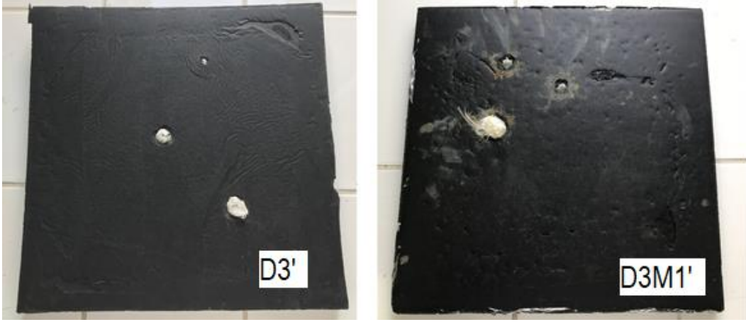
Şekil 3.4: D3 ve D3M1 panellerinin atış sonrası arka yüzey görünümü.
