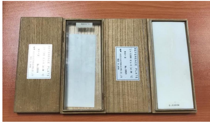
Şekil 2.30: Isı iletimi kalibrasyonunda kullanılan referans plakalar.
