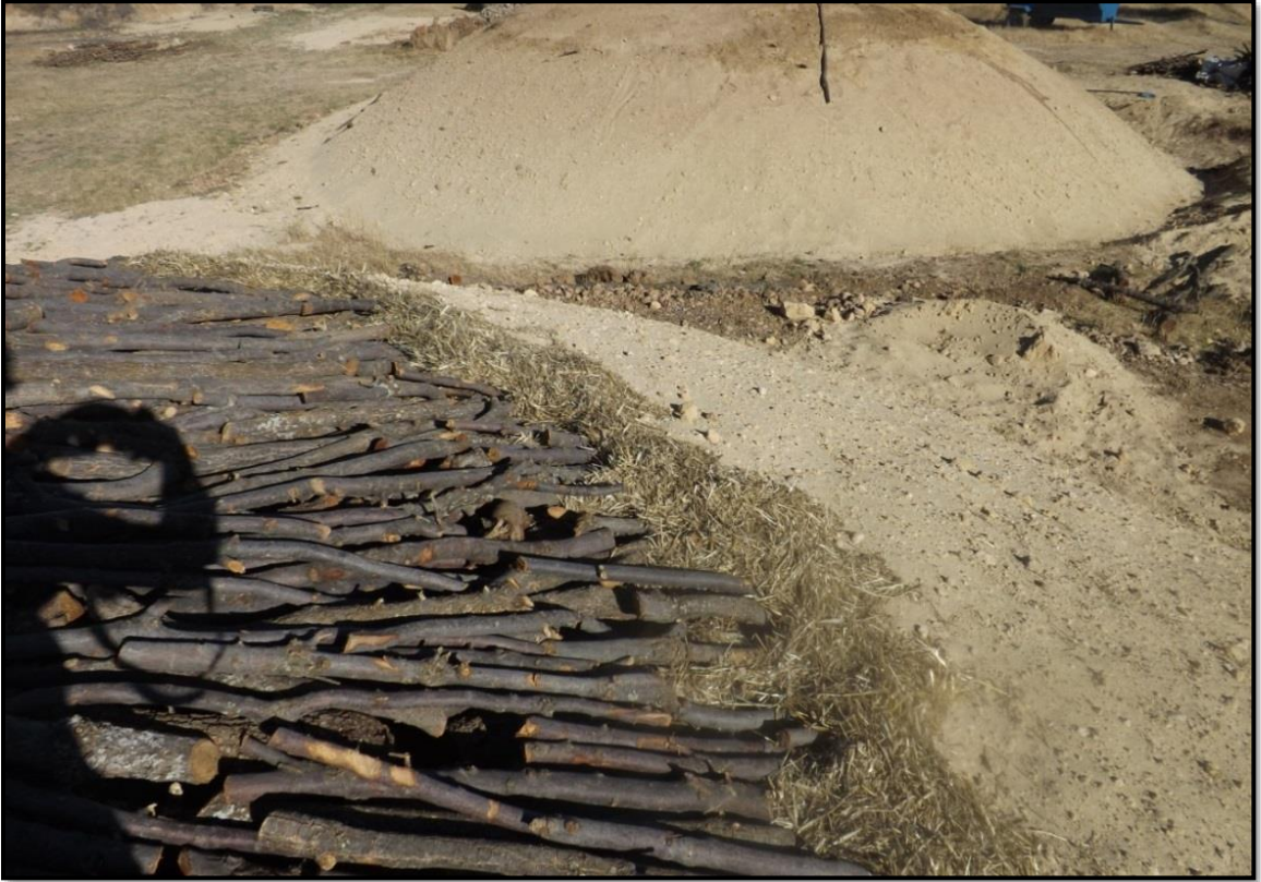
Şekil 15: Torlukta istifin üzerinin saman ve özel toprakla kaplanması.
