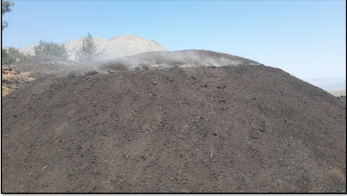
Şekil 16: Torluk üzerinde açılan hava delikleri.
