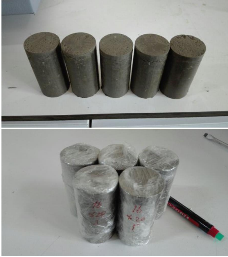
Şekil 3.15: Numunelerin kür işlemi için hazırlanması.
