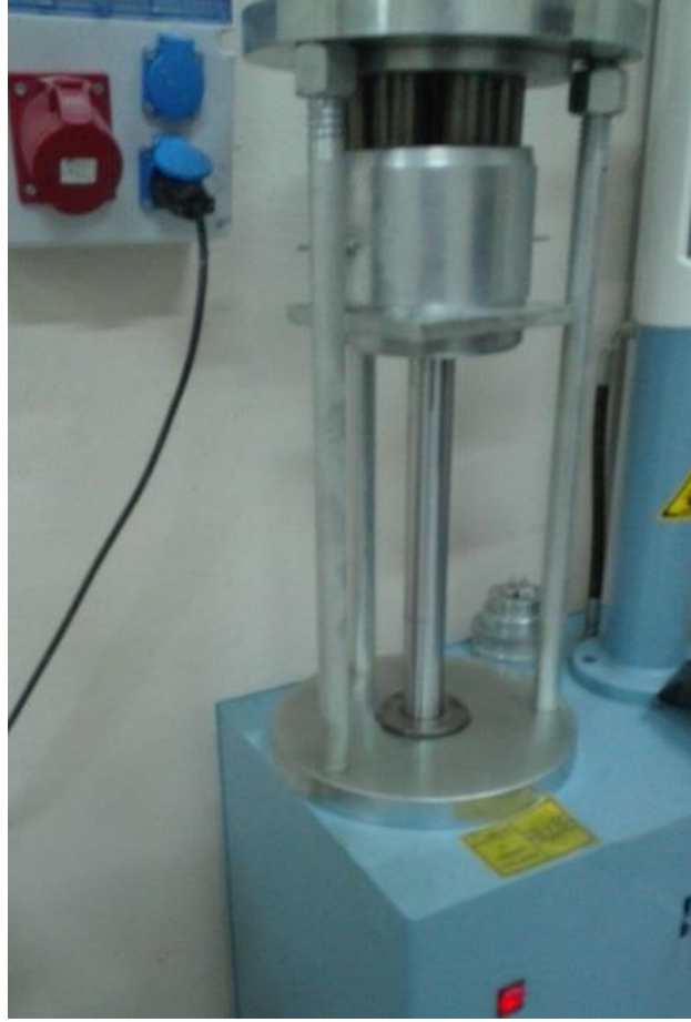
Şekil 3.14: Numune alıcıların kalıba batırılması.
