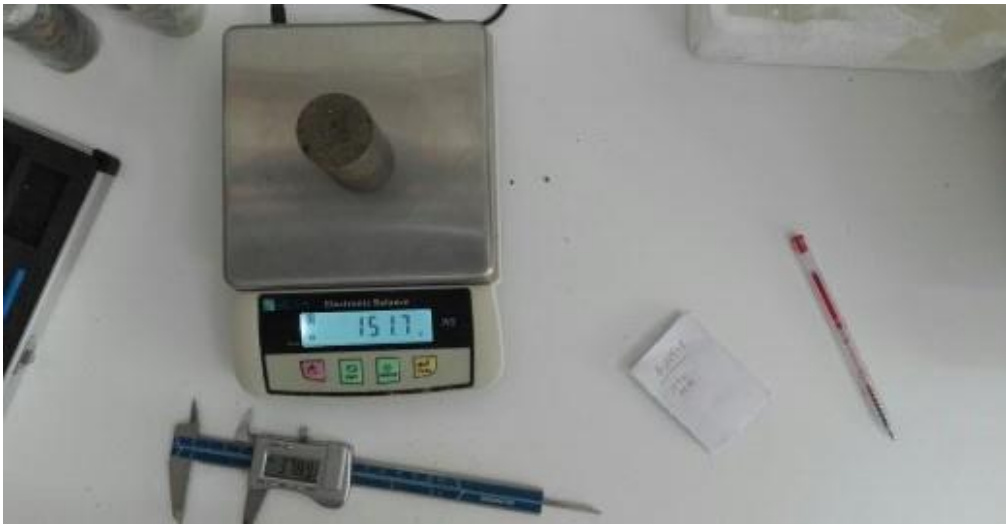
Şekil 3.18: Numunelerin çap, boy ve ağırlıklarının ölçülmesi.
