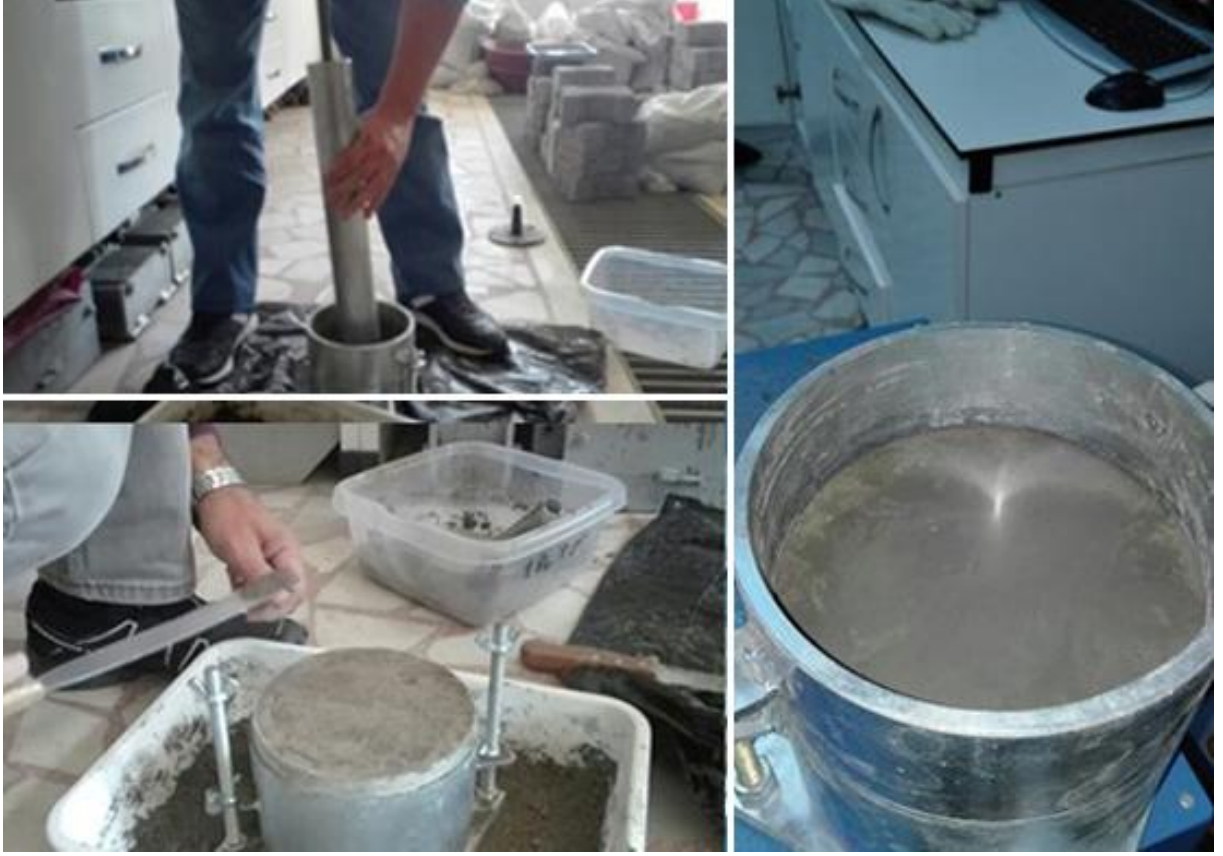
Şekil 3.13: Standart enerjiyle sıkıştırılan kalıplar.
