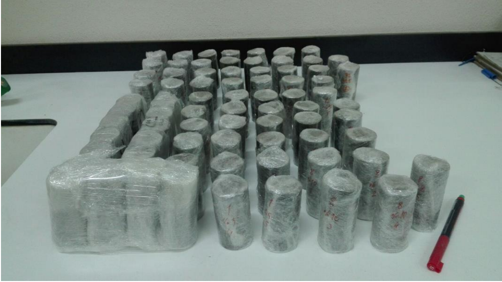
Şekil 3.16: Numunelerin kür sürelerini beklemek üzere saklanması.
