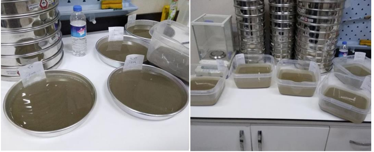
Şekil 3.3: Islak elek analizi deneyine ait fotoğraflar.
