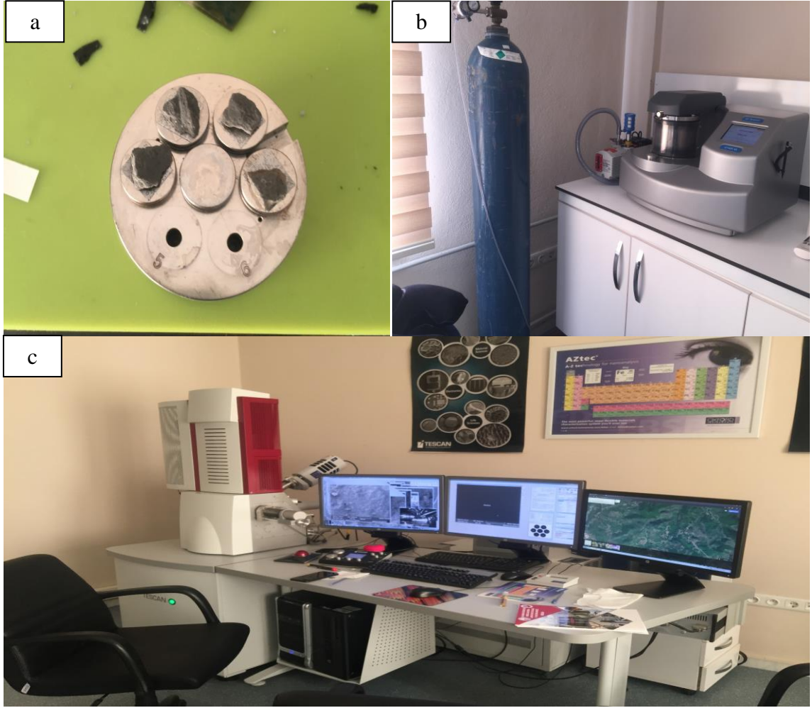
Şekil 3.15: a. Numunelerin mile yerleştirilmesi, b. kaplanması ve vakumlanması, c. analizi.
