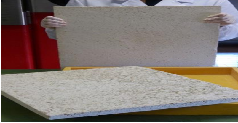
Şekil 2.1: 55×47×3 cm ebatlı, geopolimer esaslı levhalar.
