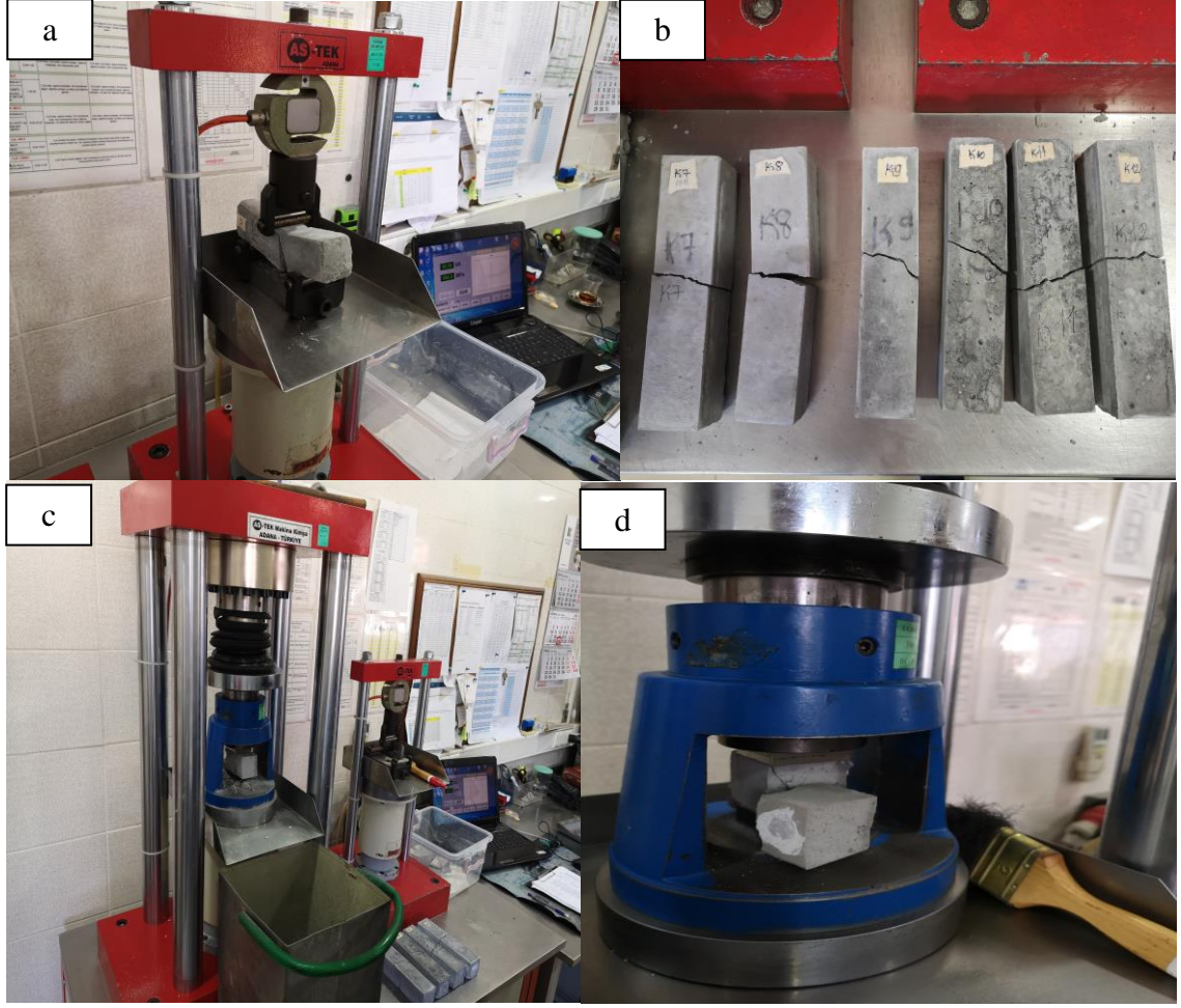
Şekil 3.12: a. Eğilme cihazı, b. numunelerin bölünmesi, c. basınç presi, d. basınç testi.
