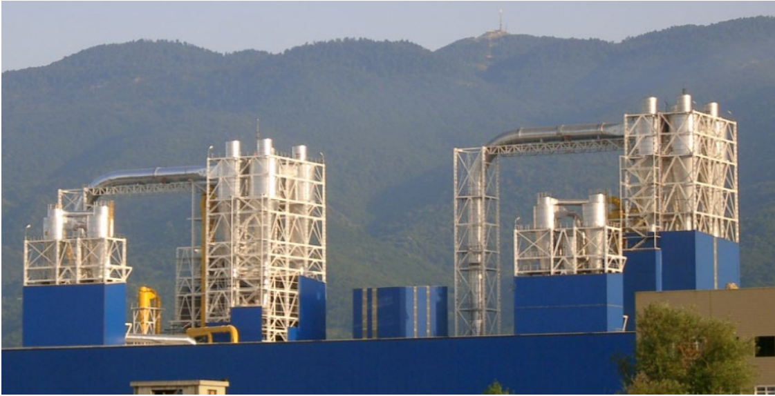
Şekil 1.56: Lif Kurutma Sistemi (URL-35, 2017)
