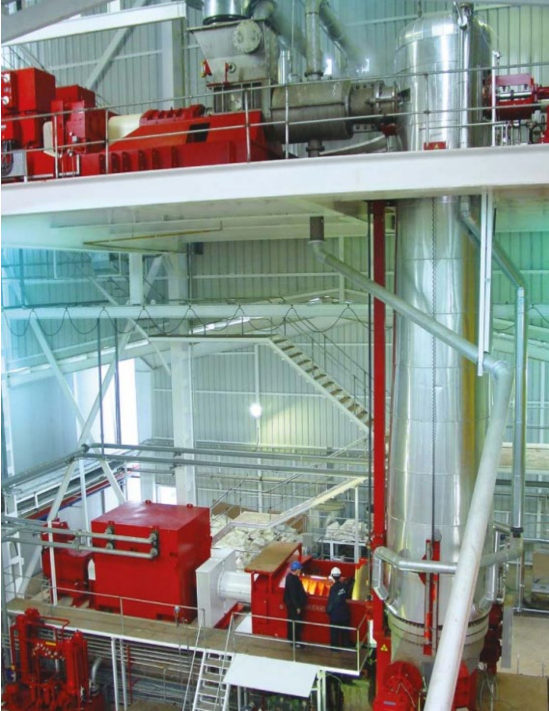
Şekil 1.8: Liflendirme Ünitesi-Refiner (URL-8, 2018)
