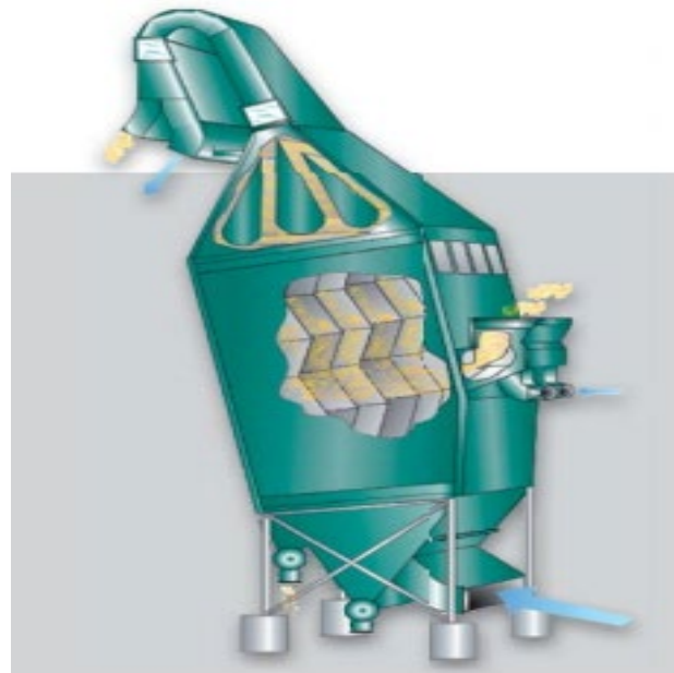
Şekil 1.57: Havalı Ayırıcı (Z Sifter) (URL-36, 2015)
