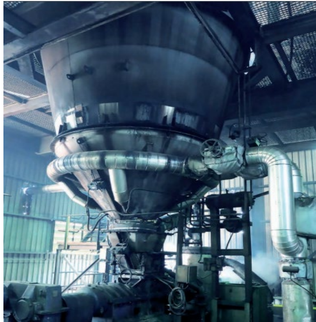
Şekil 1.46: Chip Bin (Ön Pişirme-Buharlama) (URL-25, 2018)
