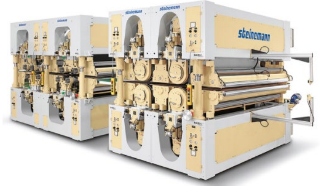
Şekil 1.66: Zımpara Makinesi (URL-45, 2018)
