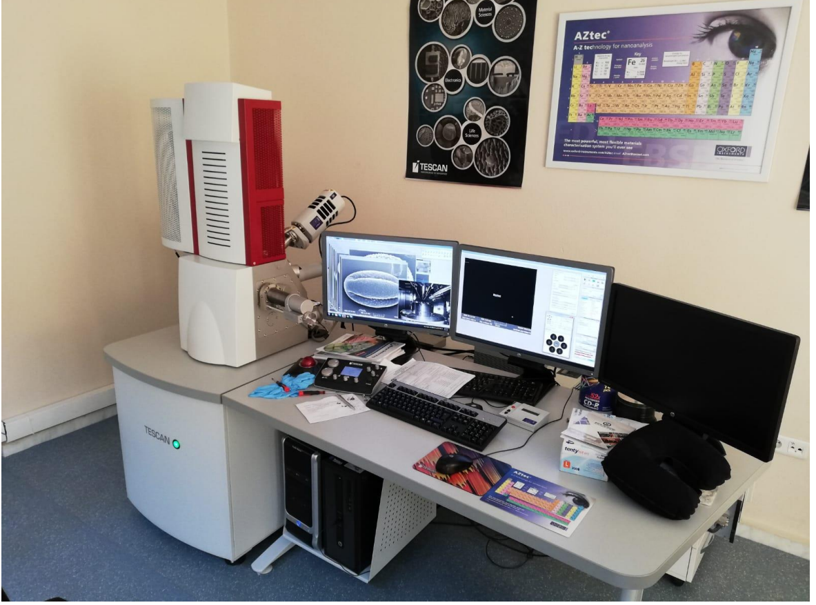
Şekil 2.1 Taramalı Elektron Mikroskopunun görünüşü.
